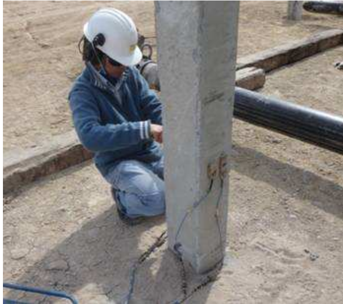
Figura 7 – Acelerômetro e transdutor de deformação (Fonte: própria do autor)
