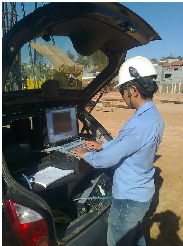
Figura 9 – Captação do sinal do golpe do martelo aplicado na estaca (Fonte: própria do autor)
