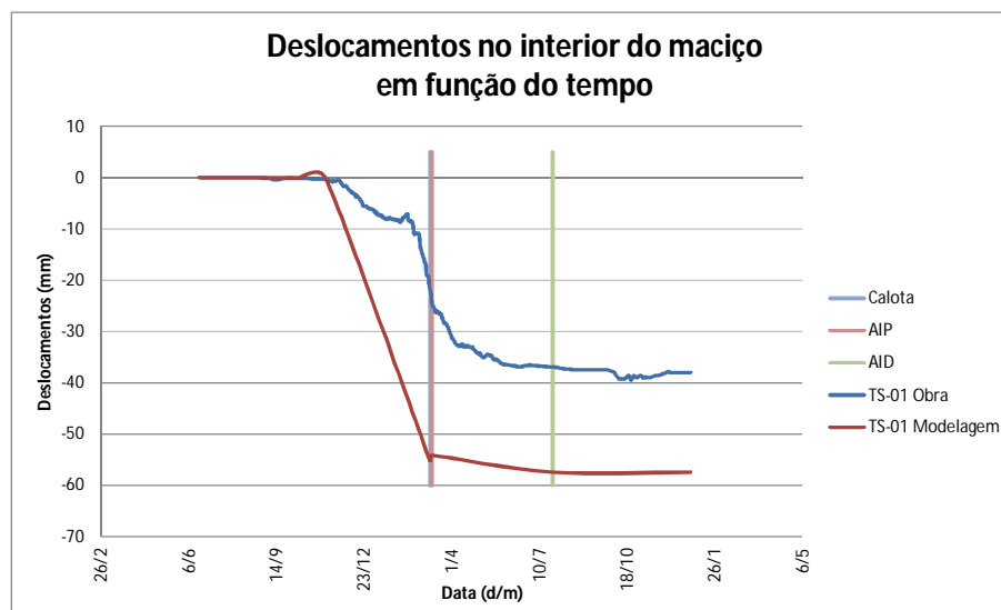
Figura 99 Deslocamentos no interior do maciço em função do tempo: análise numérica x obra – Cenário 2
