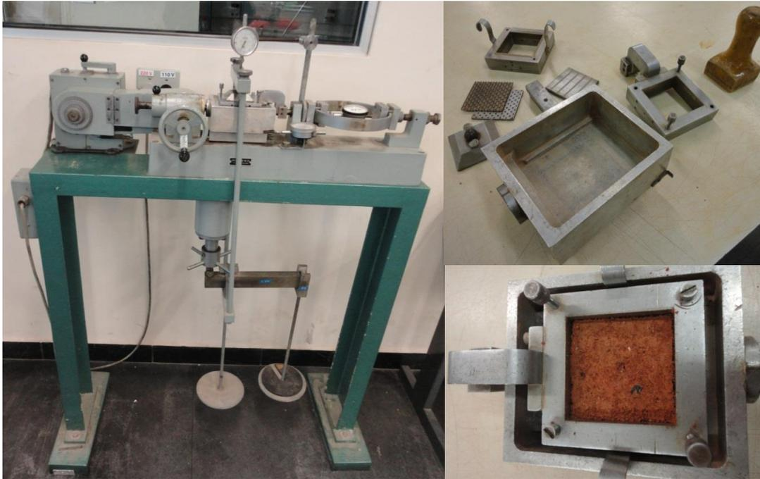
Figura 6.7 Prensa e componentes para o ensaio de cisalhamento direto
