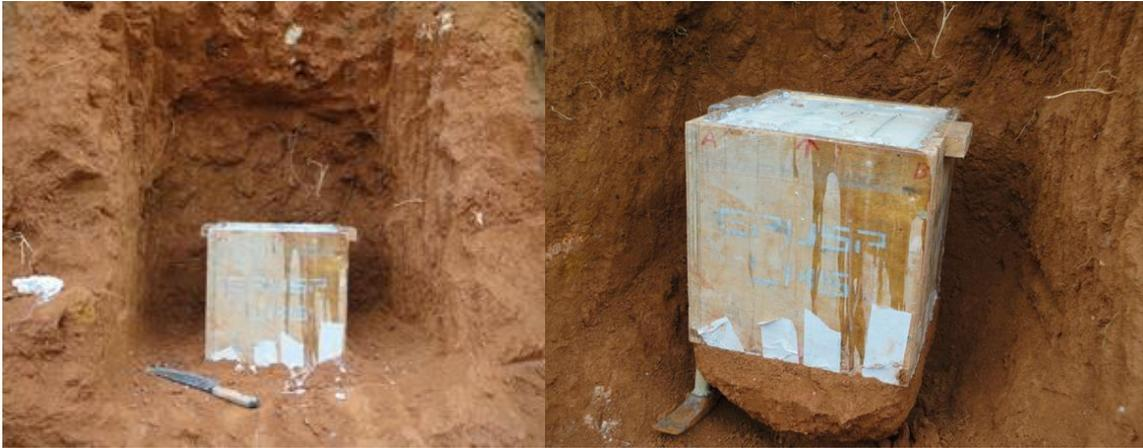
**Figura 6.4 Amostragem do segundo bloco indeformado - colúvio**
