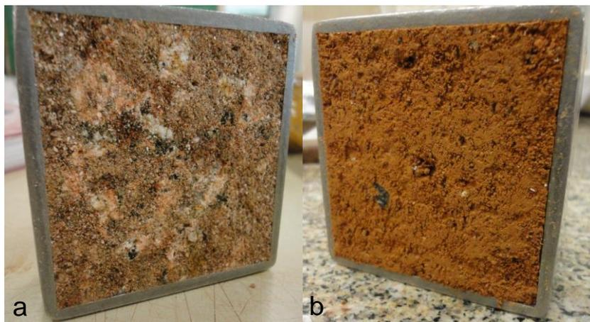
Figura 6.14 Corpos de prova: (a) residual e (b) colúvio
