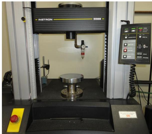
Figura 5.18 Prensa utilizada nos ensaios de *squeeze flow*
