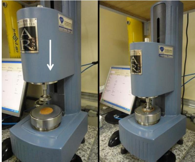
**Figura 6.28** Posicionamento da AR 550 para ensaio
