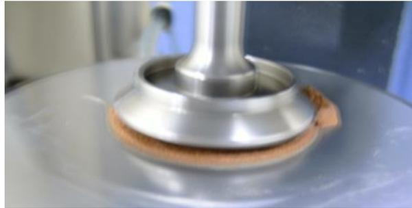
**Figura 7.28** Perda de contato entre a amostra e a punção no final do ensaio
