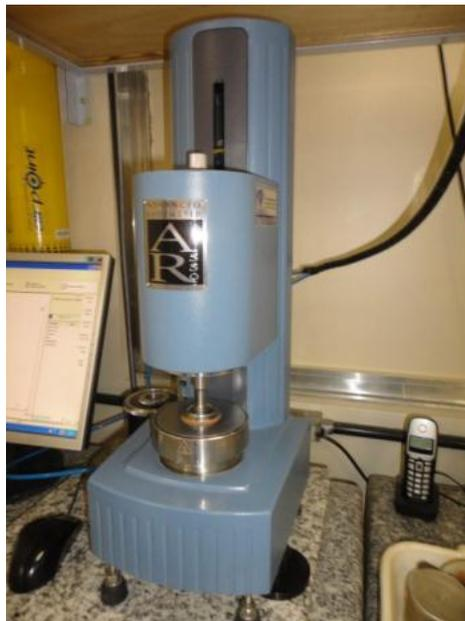
**Figura 5.12 Aparelho do ensaio de fluxo**
