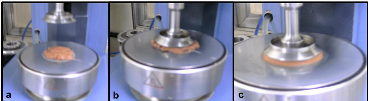
**Figura 6.29** Procedimento de posicionamento da amostra para ensaio
