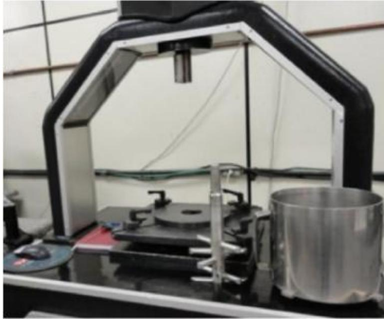
**Figura 5.35 Reômetro Rotacional utilizado por Melo et al. (2012)**
