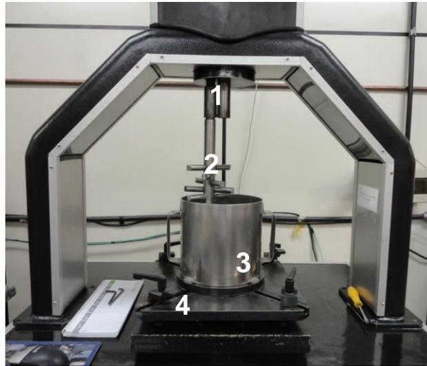
**Figura 5.9 Reômetro rotacional de torque**
