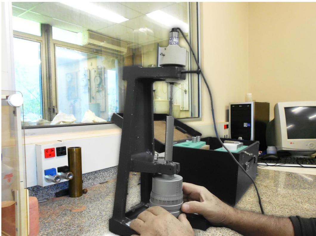
Figura 3.8 - Micrômetro para calibração de deslocamento axial.
