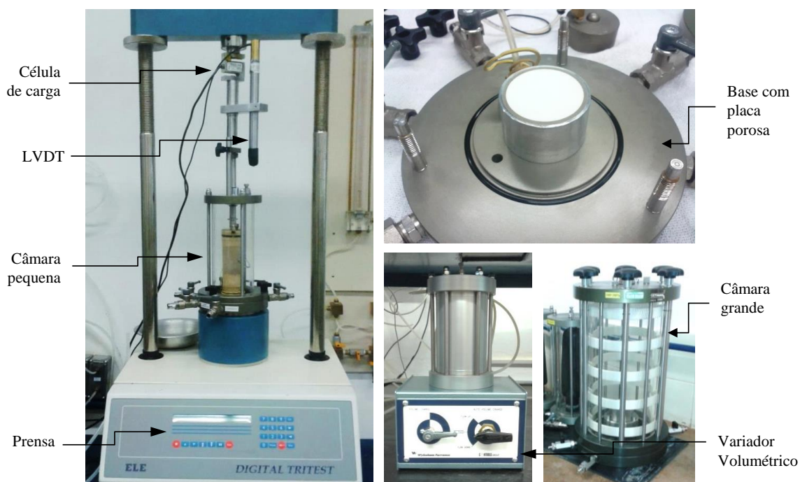
Figura 23 – Equipamentos para ensaios de compressão triaxial convencionais e com sucção controlada
