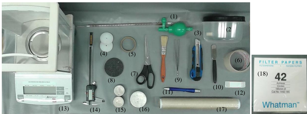
Figura 17 - Materiais utilizados no ensaio de papel filtro
