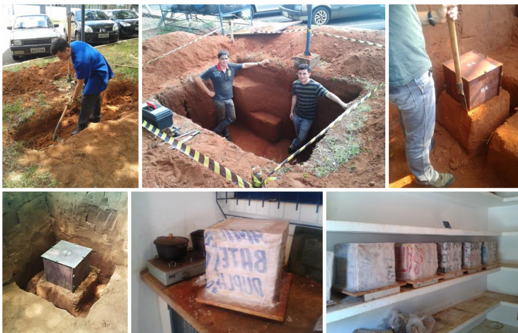
Figura 15 - Etapas da coleta de amostras de solo
