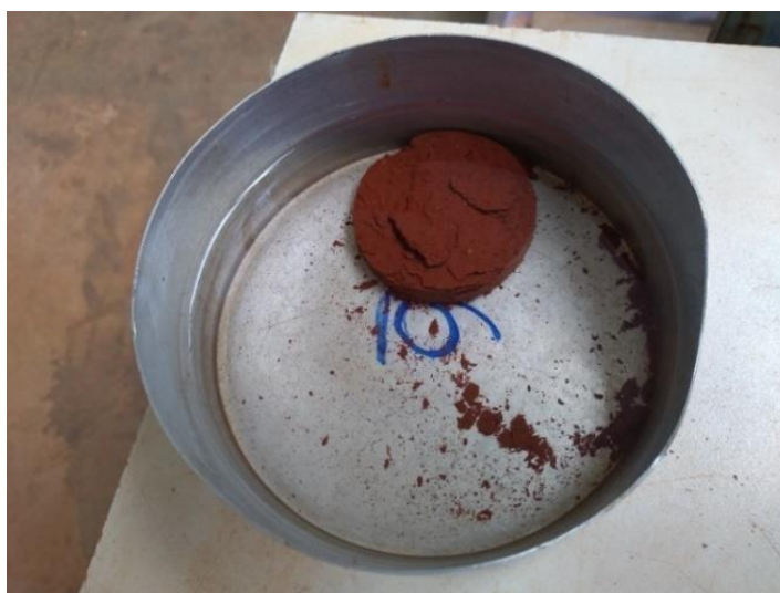
Figura 3.15 – Desprendimento em forma de monobloco.
