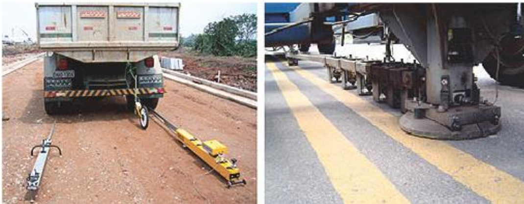
Figura 2.15 – Equipamentos Viga Benkelman (esquerda) e FWD (direita). (Fonte: http://techne17.pini.com.br/engenharia-civil/126/artigo287473-3.aspx )
