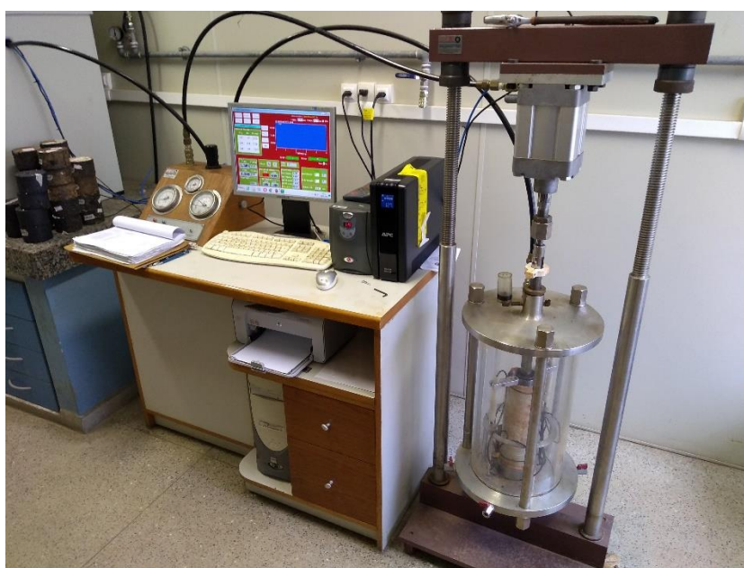
Figura 3.22 – Vista geral do equipamento triaxial de cargas repetidas do Laboratório de Pavimentação da UFJF.
