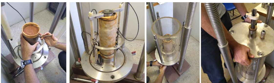
Figura 3.21 – Procedimento de aparelhagem e preparação para realização do ensaio triaxial de cargas repetidas.
