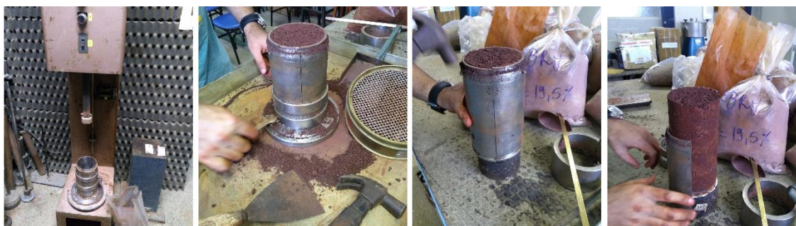
Figura 3.20 – Procedimento de compactação e desmoldagem do corpo de prova da amostra #NOV para realização do ensaio triaxial de cargas repetidas.
