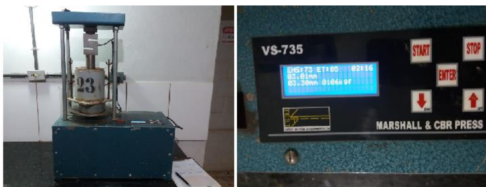
Figura 3.18 – Detalhe da prensa automatizada utilizada nos ensaios CBR.
