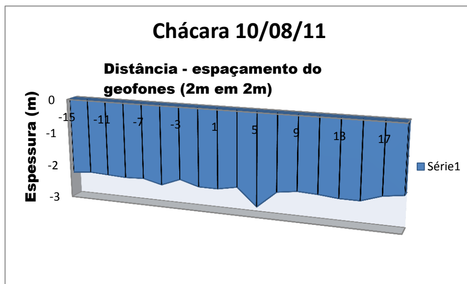
Fig. 5.15 - Perfil da areia saturada de água e suas espessuras; o solo é o perfil que vai do geofone -15 ao 17.
