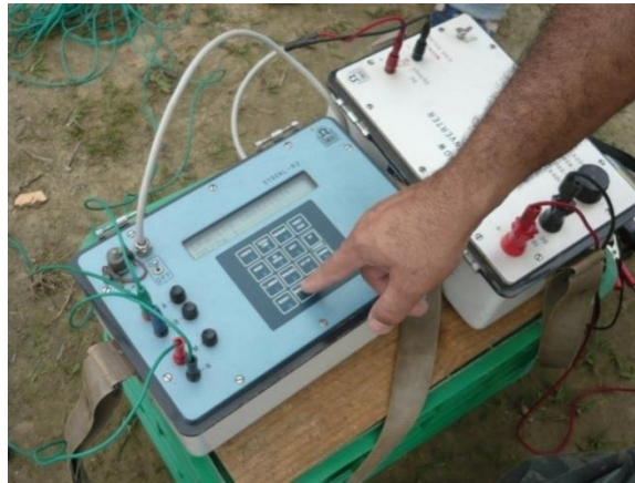
Fig.4.2 – Aparelho Siscal R2, composto de uma fonte controlada de corrente elétrica e uma unidade de recepção para leitura de potencial.
