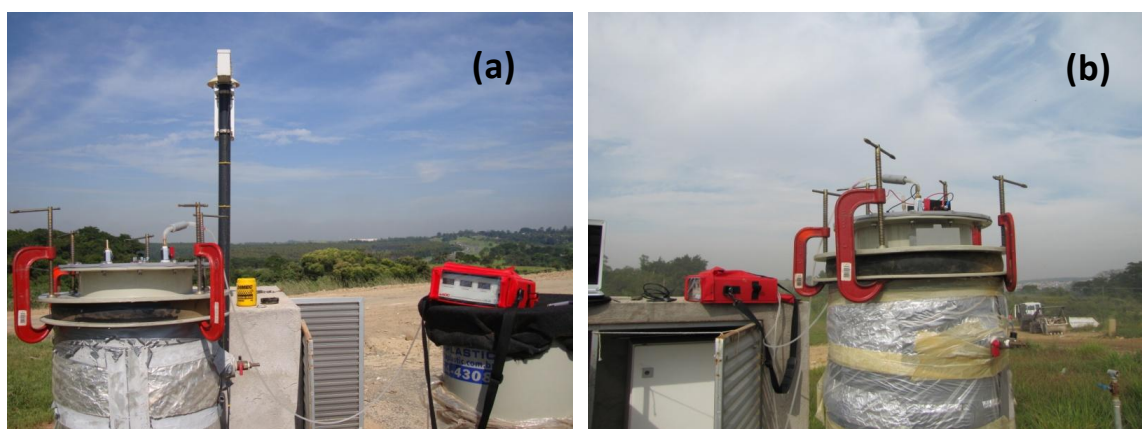
Figura 32 Foto da medição indireta da vazão nos biofiltros BF1 (a) e BF2 (b)
