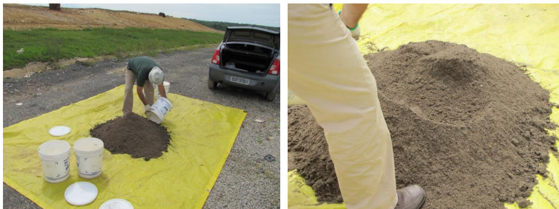
Figura 28 Homogeneização do material da mistura oxidativa do BF2 em campo
