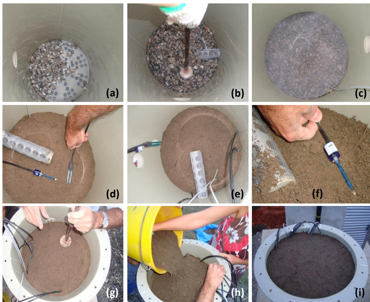
Figura 24 Montagem do biofiltro BF1
