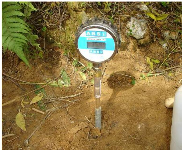
**FiguraA.3 Tensímetro coletando dados**
