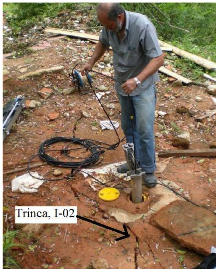
**Figura 4.24** Trinca devido ao deslocamento da massa de solo
