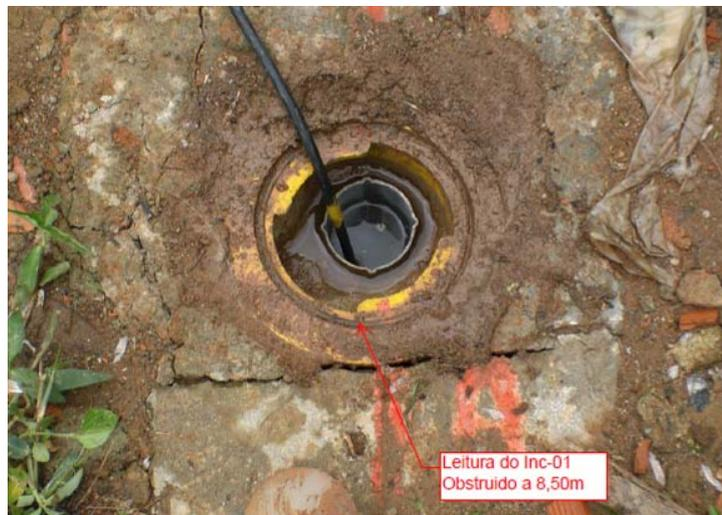
**Figura 4.19 Inclinômetro I-01 preenchido com água**
