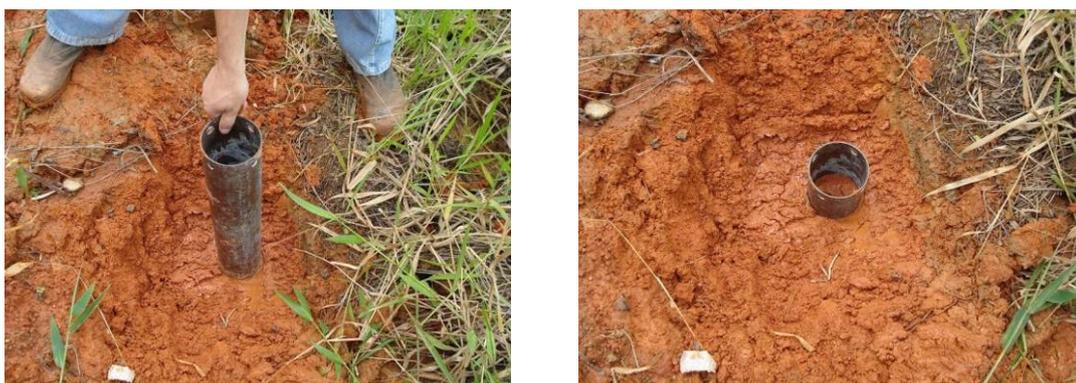
**Figura 3.12 Cravação do Tubo 1 , próximo ao pé do talude**
