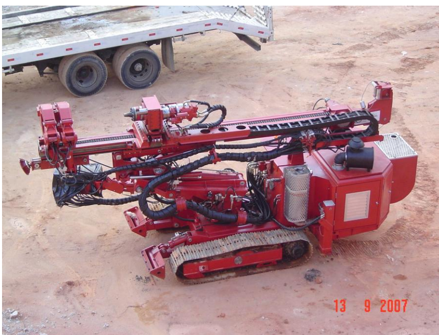
Figura 3.3 – Perfuratriz para Execução dos Tirantes.
