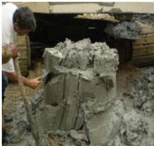
Foto 26 – Argila A.T aos 42m de profundidade
