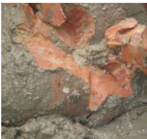
Foto 27 - Argila avermelhada aos 56,0m de profundidade
