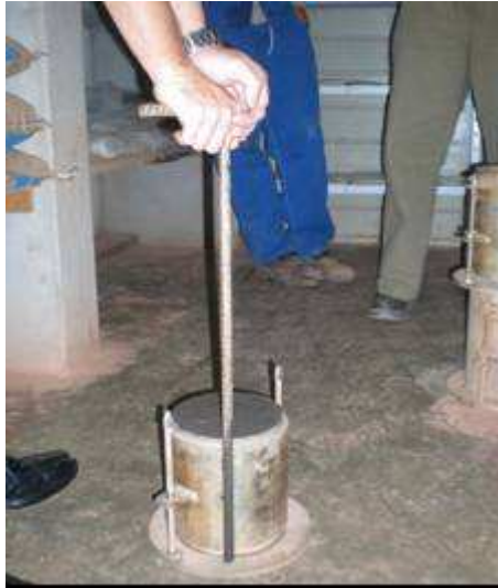
Figura 6.12 - Análise da Resistência Através da Penetração da Barra de Ferro
