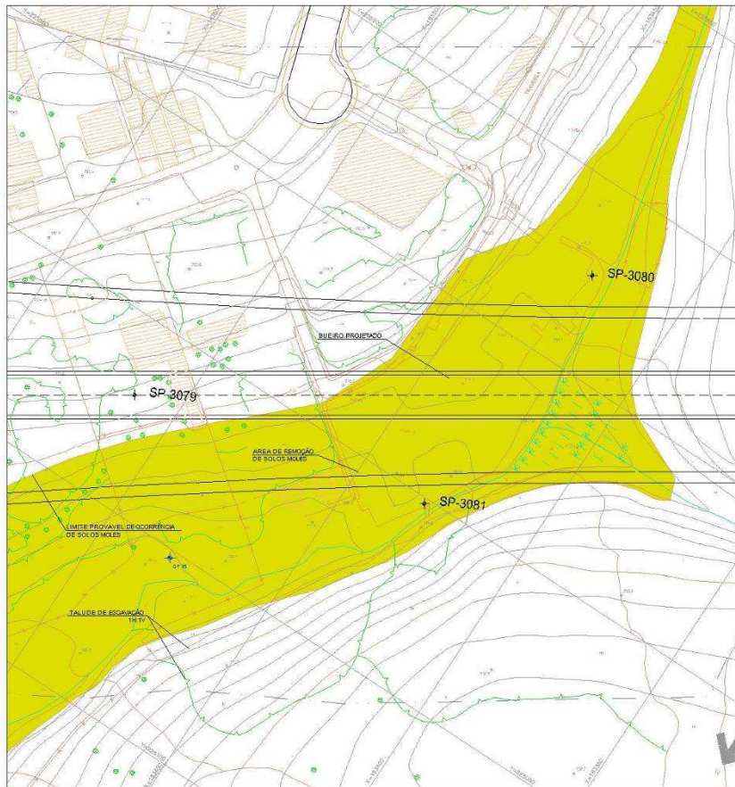
Figura 3.5 - Planta da Área 1 e locação das sondagens a percussão realizadas nesta região
