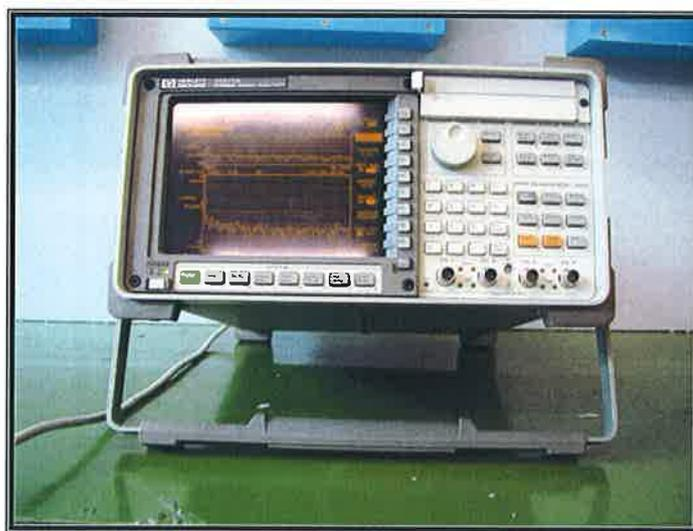
**Figura 4.10** - Fotografia do Analisador Dinâmico de Sinais HP-35670A.
