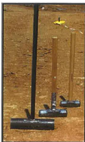
**Figura 4.7** - Fonte de impacto de tipo ativo (martelos) de 10kg, 20kg e 25kg utilizados no ensaio SASW.
