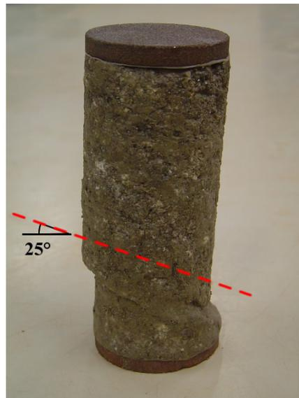
b) ruptura por extensão, ensaio (10)
