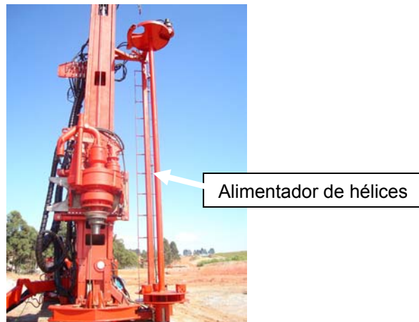
Foto 3.5 – Equipamento SD 45 – Detalhe do alimentador mecânico de hélices (ENGESTRAUSS, 2006).
