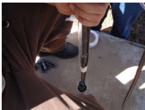
Foto 4.20. – Instalação da barra instrumentada no tubo galvanizado.
