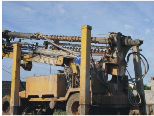
Foto 2.2 – Equipamento para execução de estacas hélice segmentada (BARRETO, 2005).
