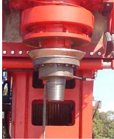
Foto 3.4. – Equipamento SD 45 – Detalhe da rosca cônica (ENGESTRAUSS, 2006).
