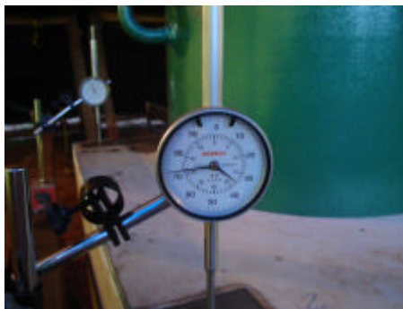
Foto 4.16 – Detalhe do relógio comparador.
