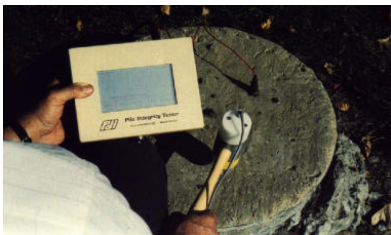
Foto 4.1 – Detalhe do martelo de mão (PDI, 2007).
