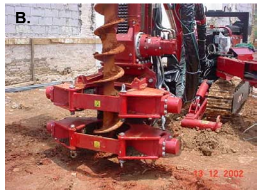
Fotos 3.3 A e B – Equipamento MD 3000 – Detalhe da Morsa (ENGESTRAUSS, 2002).
