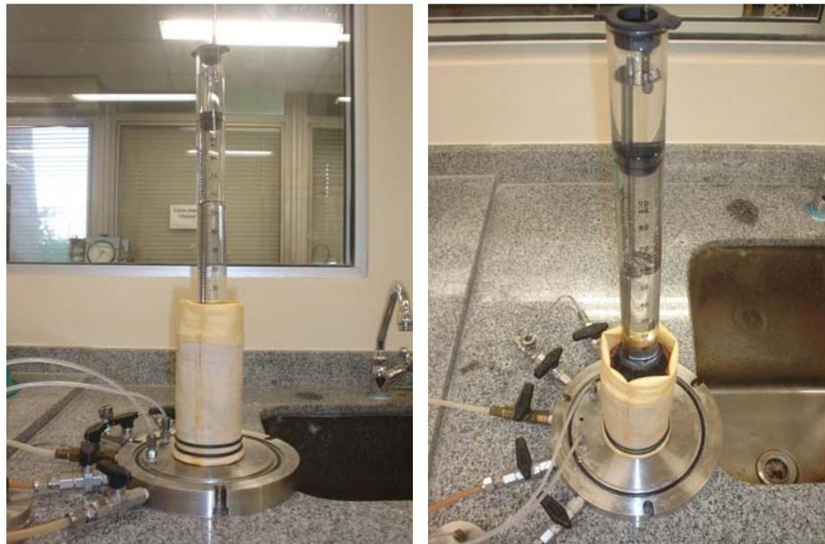
FIGURA 6.5 – ENSAIOS NO LABORATÓRIO COM O INFILTRÔMETRO DE MINI-DISCO SOBRE OS CORPOS DE PROVA.
