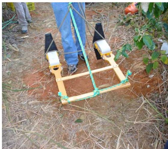
FIGURA 6.8 – ARRANJOS EMPREGADOS COM O SISTEMA GPR NA ÁREA DO PEREQUÊ-MIRIM.
