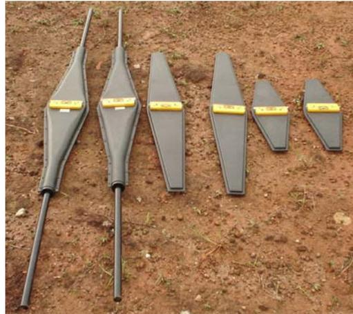
FIGURA 6.6 – SISTEMA GPR UTILIZADO PARA DETERMINAR O TEOR DE UMIDADE DO SOLO NO CAMPO.
