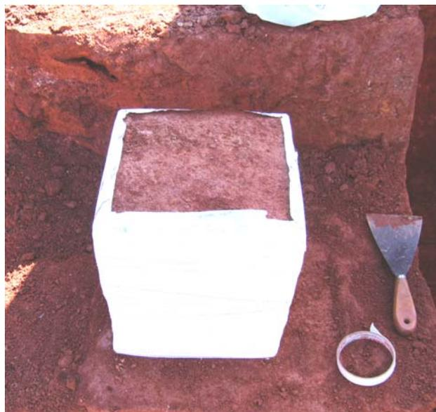
FIGURA 5.3 – COLETA DOS BLOCOS INDEFORMADOS NA ÁREA DE MARANDUBA.
