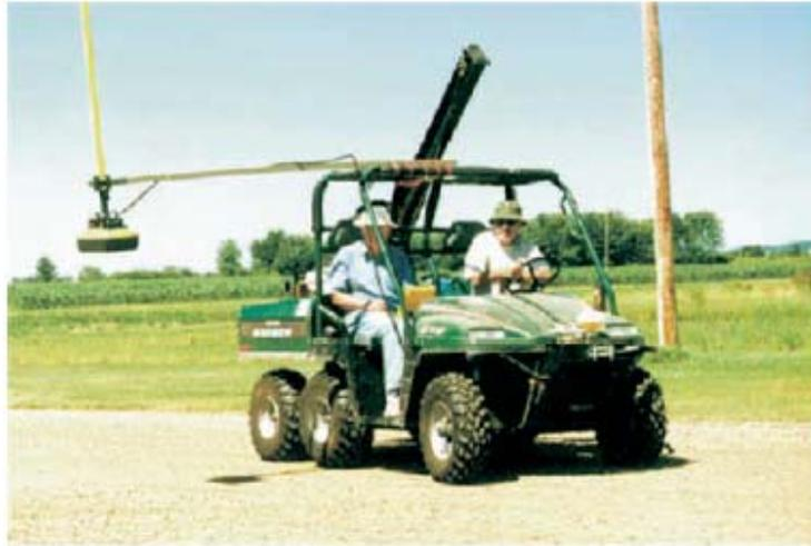
FIGURA 3.27 – SISTEMA GPR USADO PARA MEDIR A AMPLITUDE DE REFLEXÃO EM SUPERFÍCIE (HUISMAN *ET AL.* 2003).
