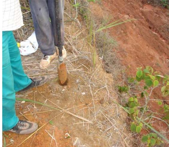
FIGURA 6.14 – COLETA DE AMOSTRAS DEFORMADAS DE SOLO PARA DETERMINAÇÃO DO TEOR DE UMIDADE GRAVIMÉTRICO EM LABORATÓRIO.
