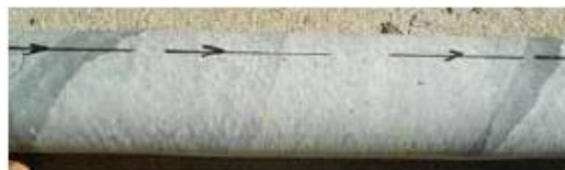
Figura 4.6 - testemunho orientado com a linha de orientação no núcleo.
