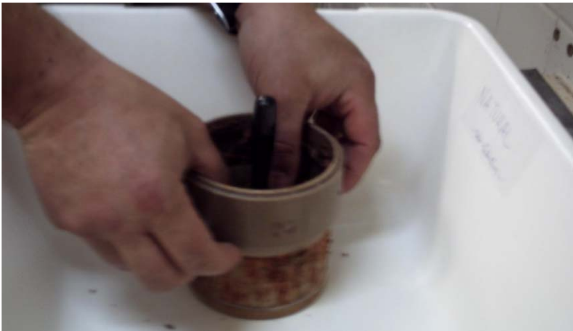
Figura 3.4 – Retirada da amostra do anel para o ensaio de desagregação
