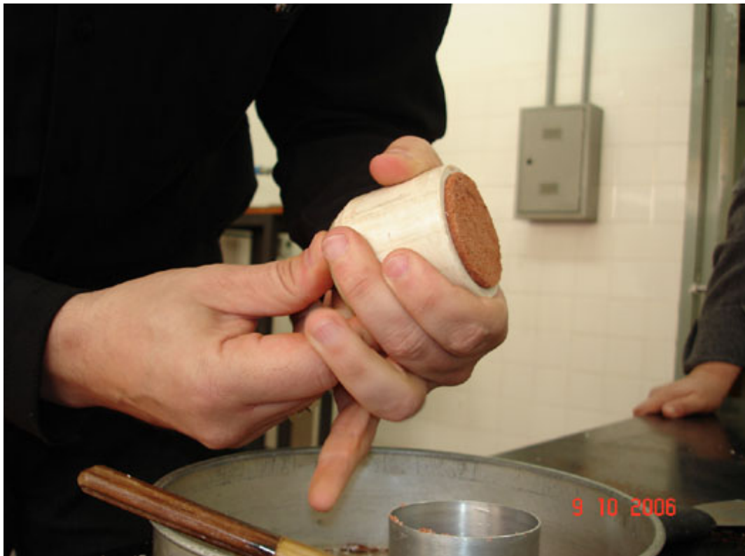
Figura 3.9 – Redução da altura da amostra no ensaio de perda de massa por imersão modificado. Fonte: Tatto (2007)
