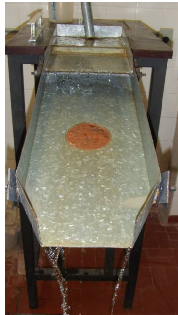
Figura 3.13 – Amostra sendo erodida sob ação do fluxo na rampa.
