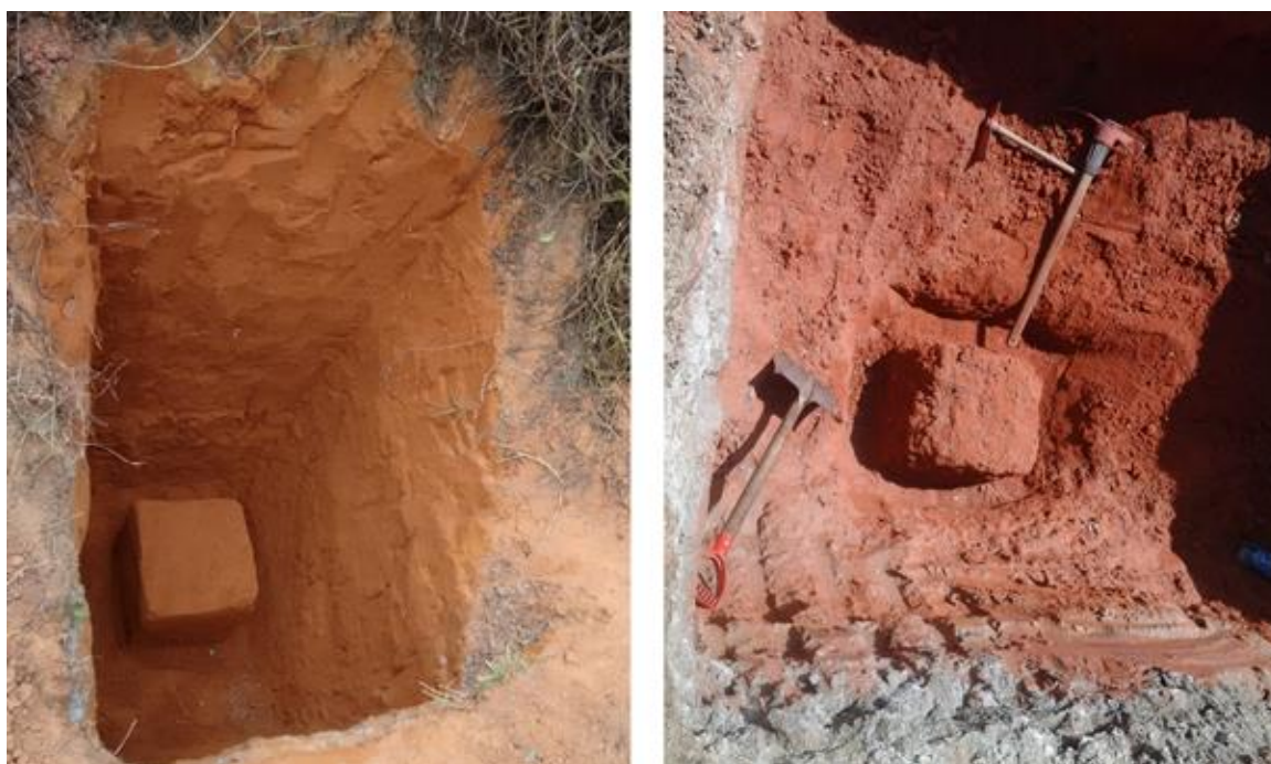
Figura 35 - Retirada das amostras indeformadas (blocos)
