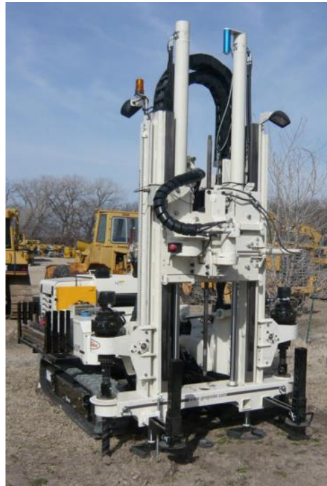
Figura 32 - Equipamento para cravação de ponteira CPTU, com capacidade de cravação de até 20 tf
