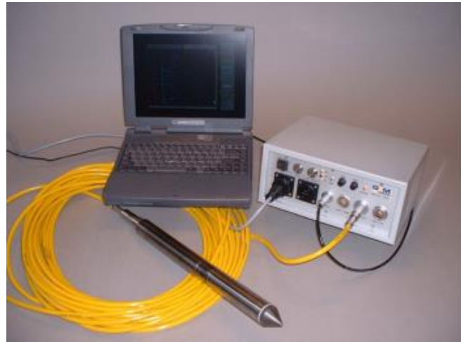
Figura 31 - Cone e caixa de dados para ensaios CPTU
