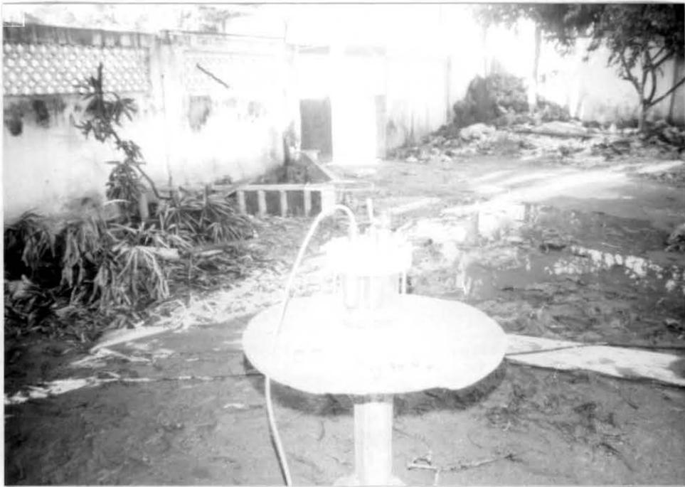
Figura IV.7 - Câmara de saturação levada para o campo.
