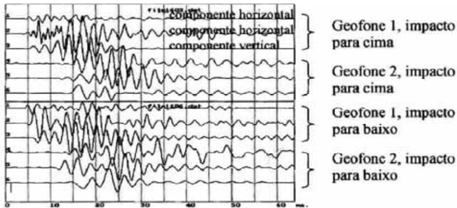
Figura 4 - Resultado típico de um ensaio cross-hole (adaptado de Giacheti et al , 2006).
