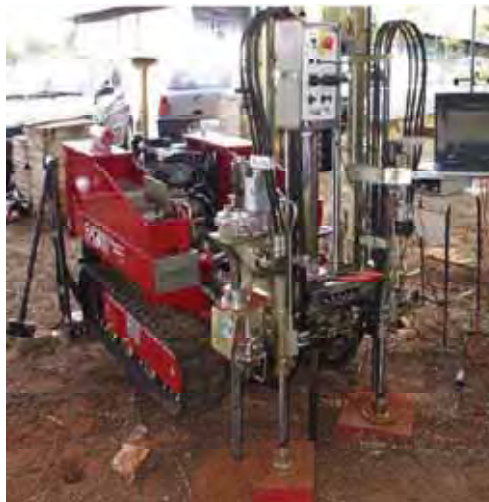
Figura 35 - Penetrômetro multi-função durante ensaio SCPT.
