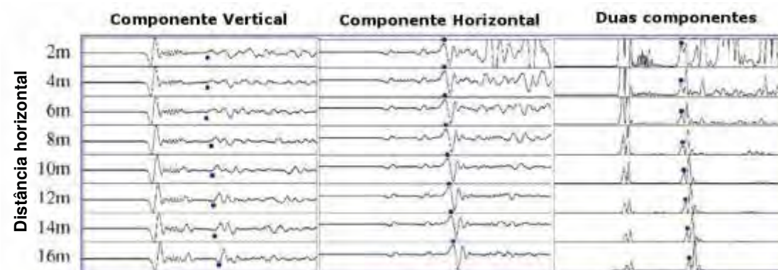
Figura 28 - Simulação de sinal gerado a 39m de profundidade e recepção na superfície (Bang & Kim, 2007).
