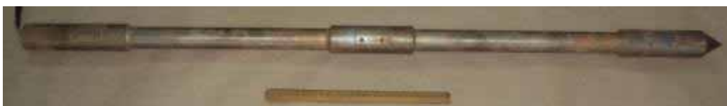
Figura 38 - Ponteira com 3 geofones desenvolvida por Vitali (2011).
