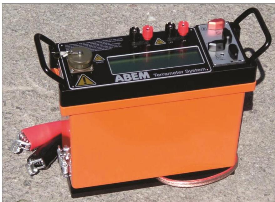
Fig. 16- Resistímetro SAS 4000, ABEM.
