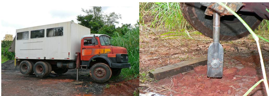
Figura 5.3 – Vista do caminhão na execução da cravação do DMT no CEUSP.
