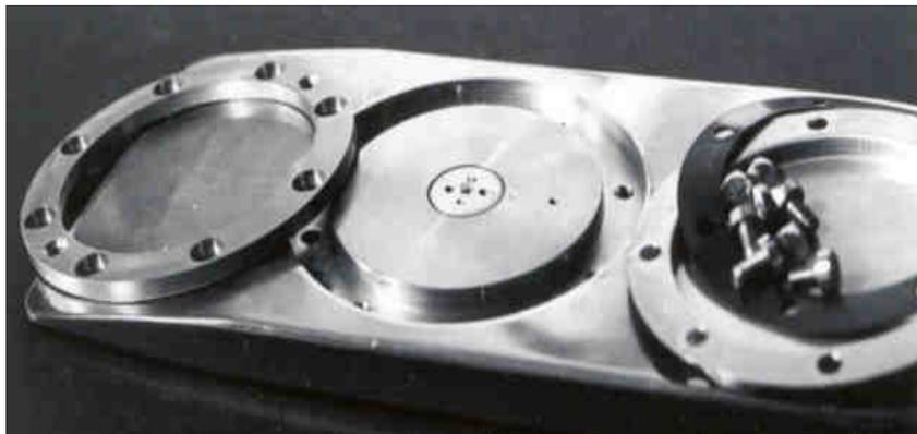
Figura 3.4- Detalhes de fixação da membrana (Marchetti 2001)
