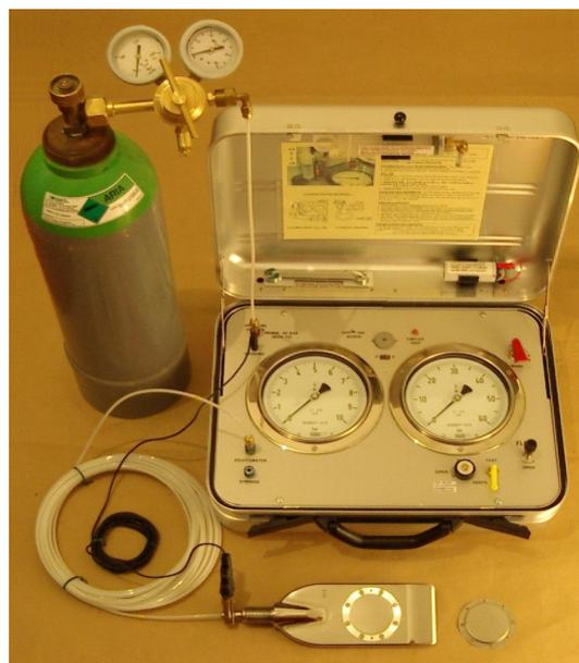
Figura 3.8 – Detalhe da unidade de controle com cilindro de gás (Marchetti 2001)
