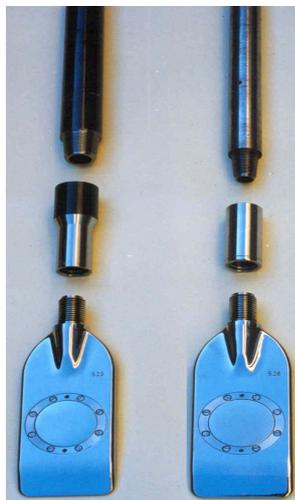
Figura 3.5- Detalhes da ligação haste/lâmina (Marchetti 2001)
