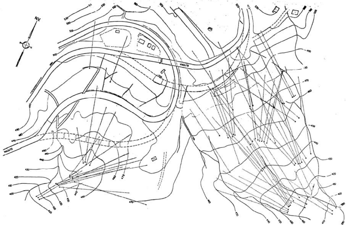
Figura 3.8 – Planta com locação dos drenos da 2ª etapa (Teixeira e Kanji, 1970).
