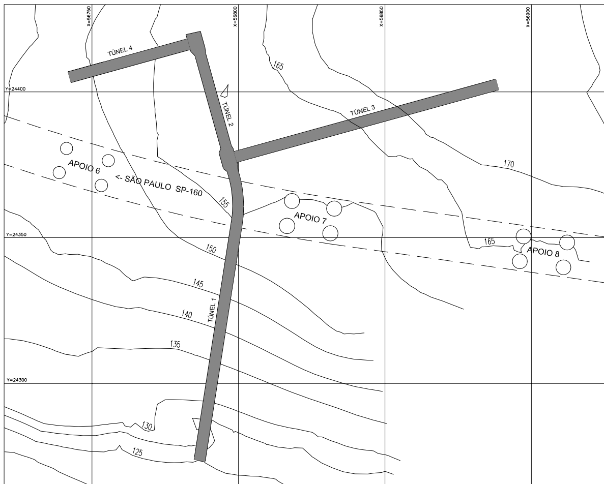
Figura 4.9 – Planta dos túneis de drenagem (Vector Projetos, 2000).
