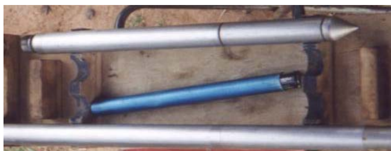
Foto 3.10. Piezocone sem fio com filtro de cavidade, utilizado nas sondagens CPTU.
