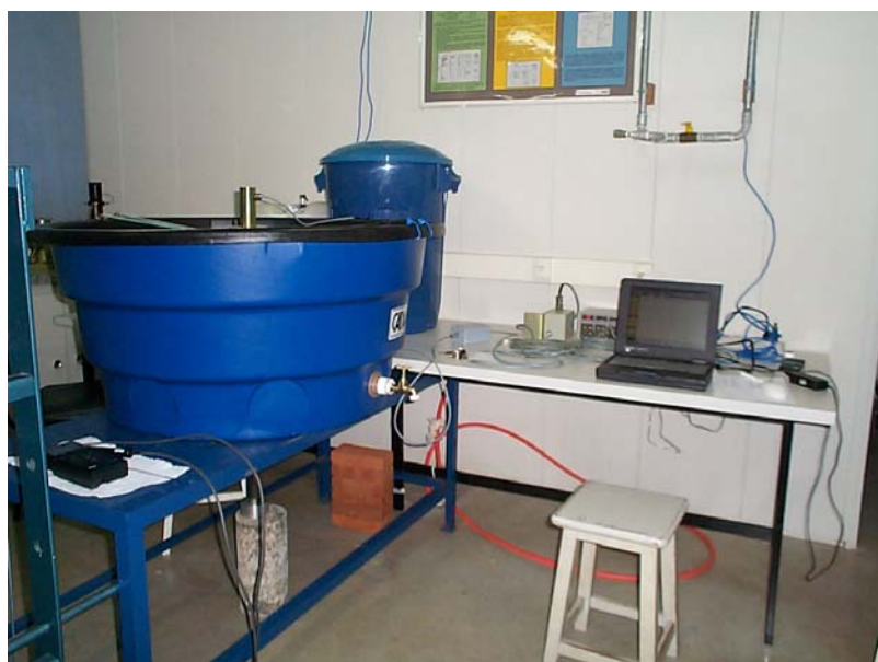
Foto 3.12. Sistema de calibração do sensor de condutividade do piezocone de resistividade.
