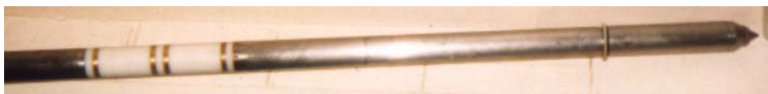
Foto 2.6. Dispositivo para medida da resistividade elétrica acoplado ao piezocone (GIACHETI, 2001).
