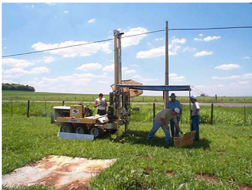
Foto 3.19. Sondagem com piezocone sendo realizada na área do lixão de Ribeirão Preto.
