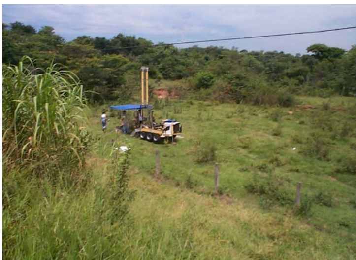
Foto 3.18. Sondagem com piezocone sendo realizada na área do aterro de resíduos sólidos de Bauru.
