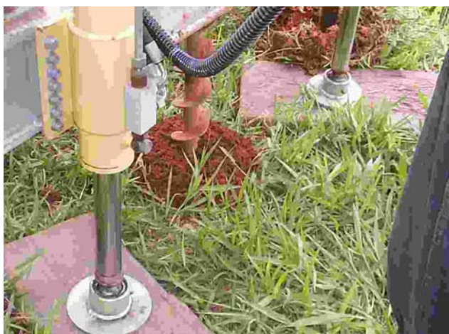
Foto 2.12. Poço de monitoramento temporário aberto com trado helicoidal motorizado.
