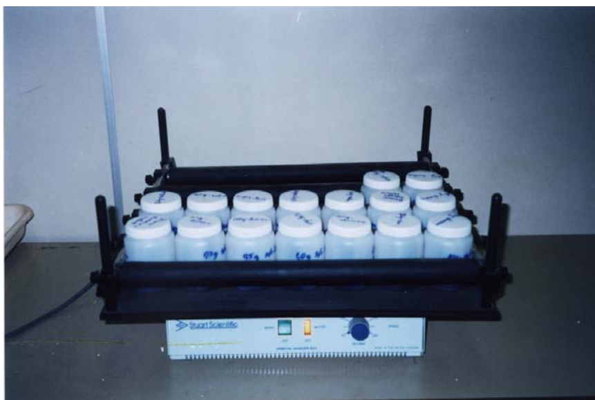
Foto 3.37. Equipamento de rotação utilizado durante os ensaios de adsorção em lote.
