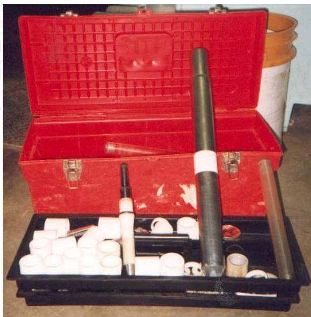
Foto 2.10. Penetrômetro UBC K BAT ao lado de uma ponta do sistema BAT (GIACHETI, 2001).
