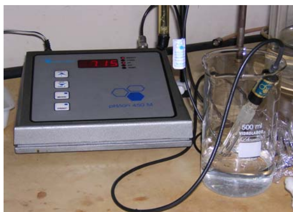
Foto 3.34. Aparelho utilizado para medir o pH da solução efluente durante os ensaios de coluna no LMS-EPUSP.
