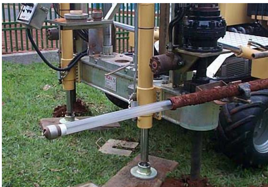
Foto2.8. Amostrador de solo utilizando o sistema direct-push de coleta de amostras.
