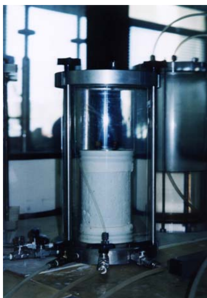
Foto 3.29. Corpo de prova já moldado dentro da célula de ensaio.
