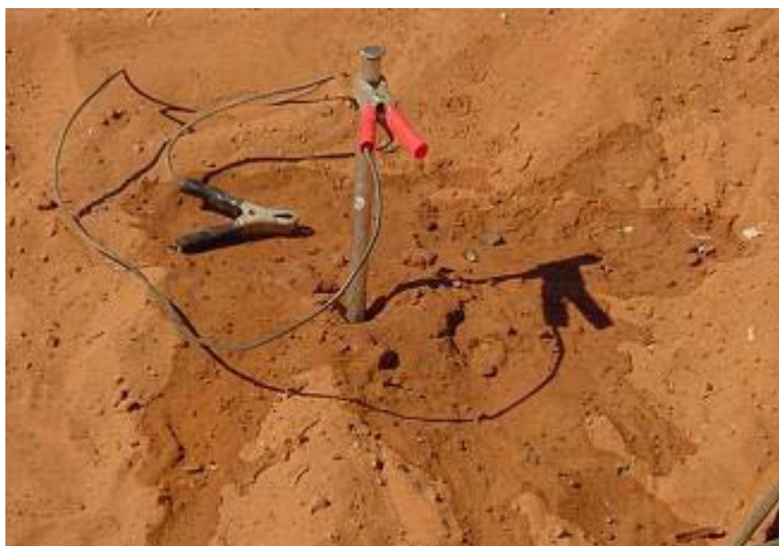
Foto 3.9. Eletrodo cravado no solo do aterro de resíduos sólidos de Bauru.
