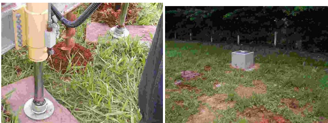
Foto 3.22. Amostragem de água no aterro de resíduos sólidos de Bauru utilizando poço temporário de monitoramento.
