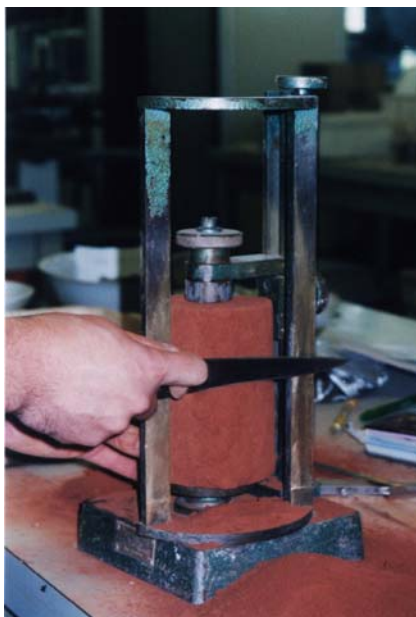
Foto 3.28. Amostra de solo do aterro de resíduos sólidos de Bauru sendo preparada para a realização do ensaio de permeabilidade.
