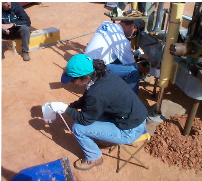
Foto 3.20. Amostragem de água no aterro de resíduos sólidos de Bauru utilizando o Geoprobe® .
