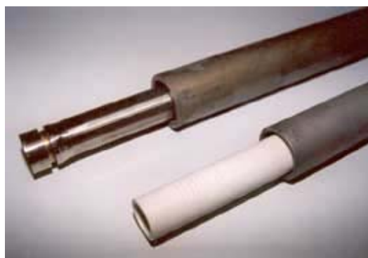
Foto 2.11. Dois tipos de filtros (aço inoxidável e PVC) do amostrador de água Geoprobe® ( http://www.geoprobe.com/products/tools/gw_sampling/gw_sampling_tools_menu.htm em 02/2004).
