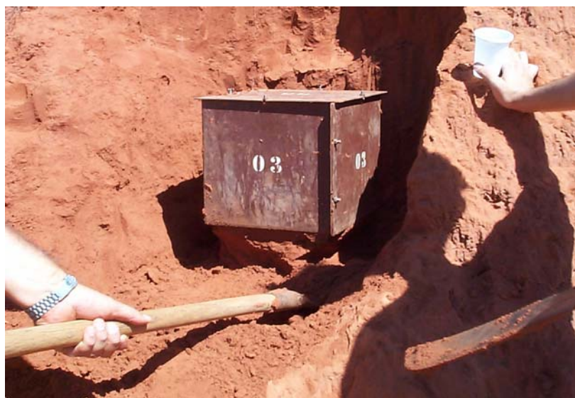
Foto 3.7. Amostra indeformada sendo coletada próximo ao pé do talude.
