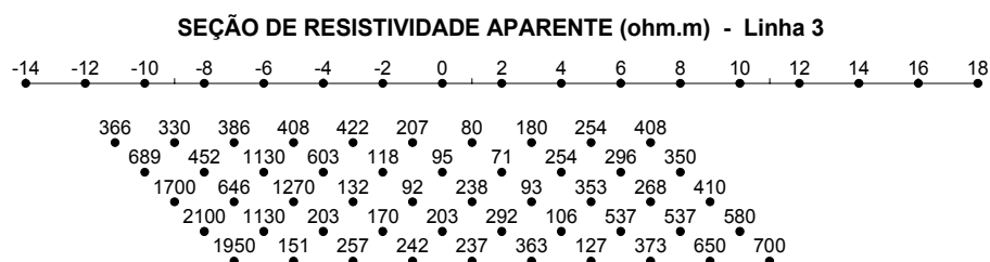
Figura 2.27. Sistema de plotagem da técnica do CE - arranjo Dipolo-Dipolo/Método da Eletroresistividade (ELIS, 1999).
