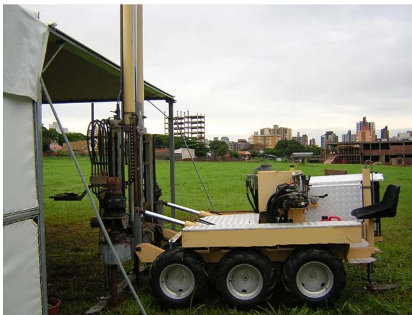
Foto 3.11. Penetrômetro multi-função utilizado nos ensaios com piezocone.
