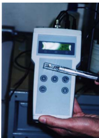
Foto 3.33. Condutivímetro utilizado para medir a condutividade elétrica da solução efluente dos ensaios de coluna no LMS-EPUSP.
