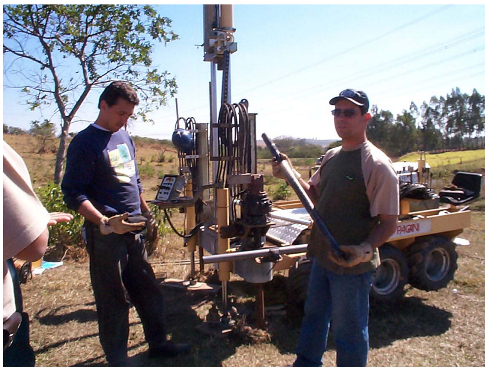
Foto 3.21. Amostragem de solo no aterro de resíduos sólidos de Bauru utilizando o Geoprobe® .
