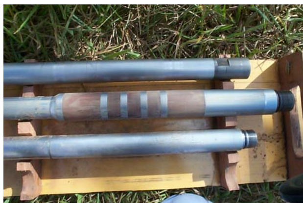
Foto 2.7. Piezocone de resistividade com quatro eletrodos dispostos em arranjo Werner .
