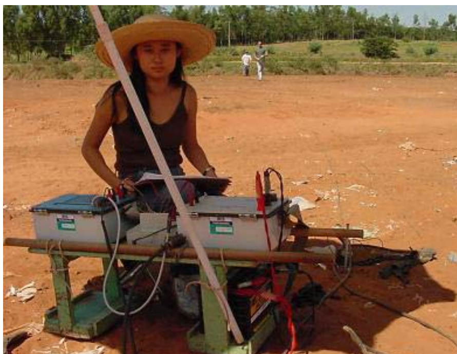
Foto 3.8. Caminhamento elétrico sendo executado no aterro de resíduos sólidos de Bauru.
