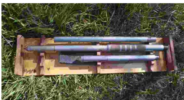
Foto 3.16. Piezocone de resistividade (RCPTU) utilizado no aterro de resíduos sólidos de Bauru.
