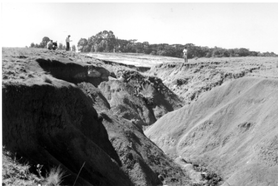
Figura 3.7. Exemplos de processos erosivos na Formação Guabirotuba, causados pela exposição de materiais expansivos (Mineropar, 1994 apud Felipe, 1999).
