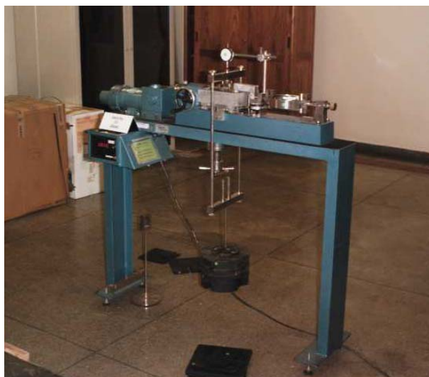
Figura 5.40. Prensa de cisalhamento direto ( Contenco ) utilizada nos ensaios.
