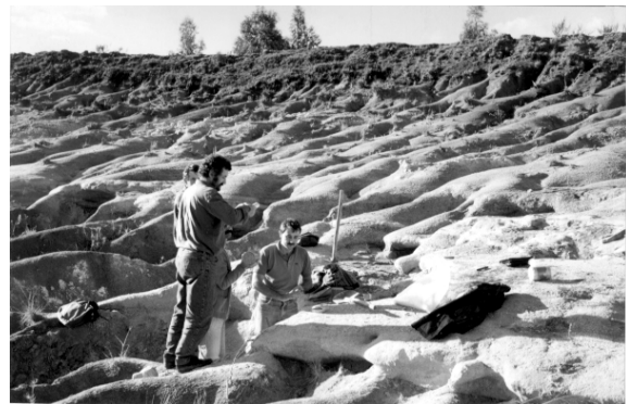
Figura 3.7. Exemplos de processos erosivos na Formação Guabirotuba, causados pela exposição de materiais expansivos (Mineropar, 1994 apud Felipe, 1999).
