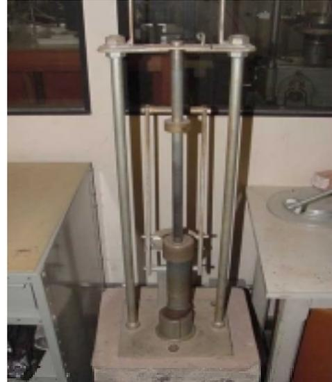
Figura 36 – Foto do equipamento do ensaio de compactação molde reduzido.
