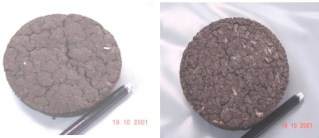
Figura 38 – Amostra da Rigesa no ensaio de adensamento após secagem em estufa.
