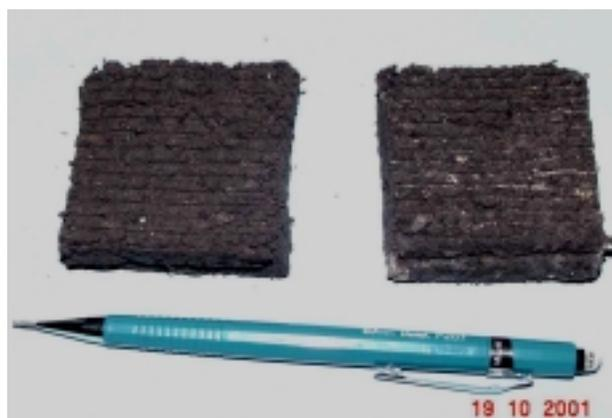
Figura 48 – Amostra da Rigesa após o ensaio de cisalhamento direto.
