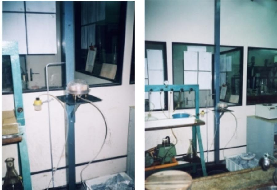
Figura 50 - Esquema do Ensaio de Placa de Sucção do Laboratório de Solos da USP-SP.
