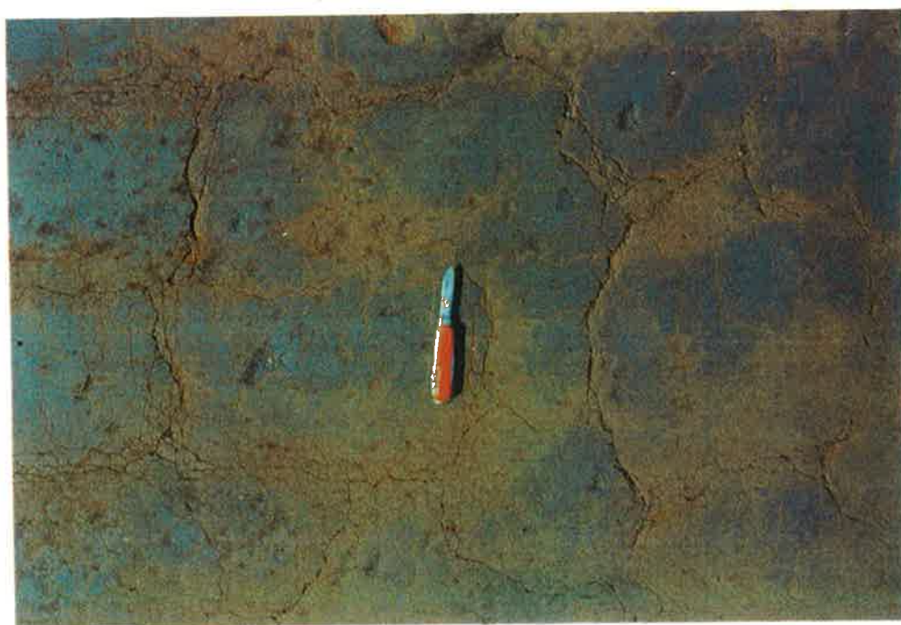
Foto 7 : Fissuração desejada, indicando coesão do material da base.
