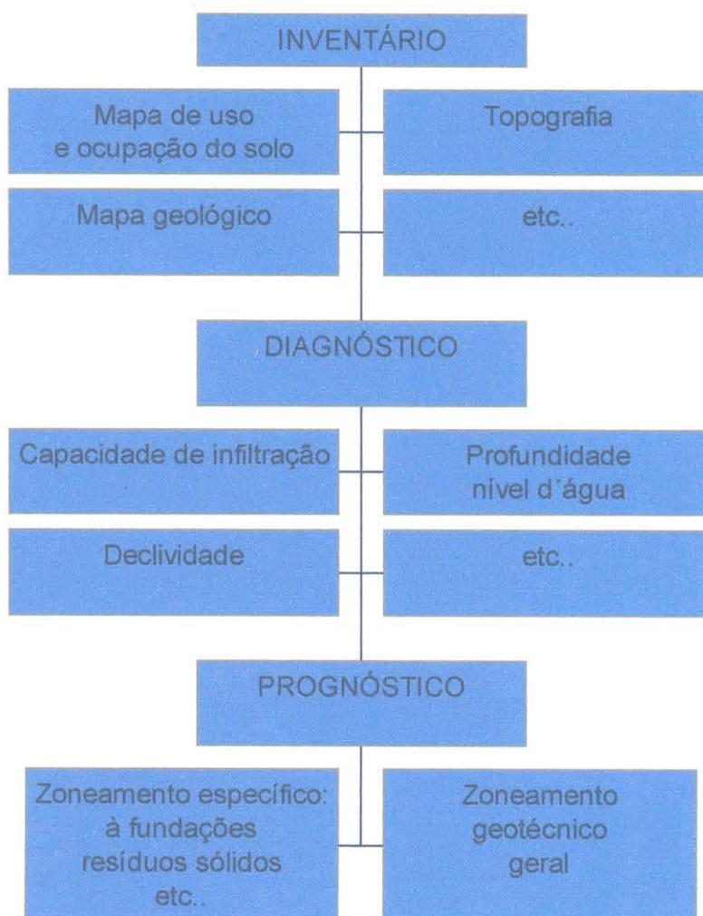
Figura 2.7 - Padrão geral de ordenamento das informações geológico-geotécnicas para fins de planejamento e uso do solo, das metodologias internacionais de cartografia geotécnica.
