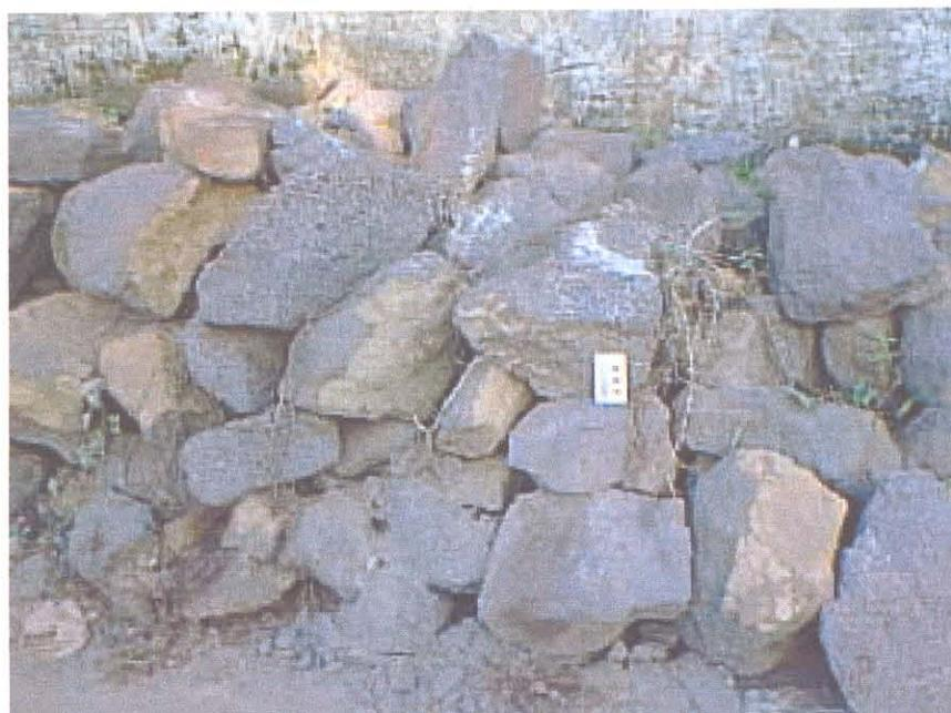
Figura 5.45 – Material a ser utilizado na fundação de casas, Horizonte Ferruginoso, fácies Arenito Ferruginizado.
