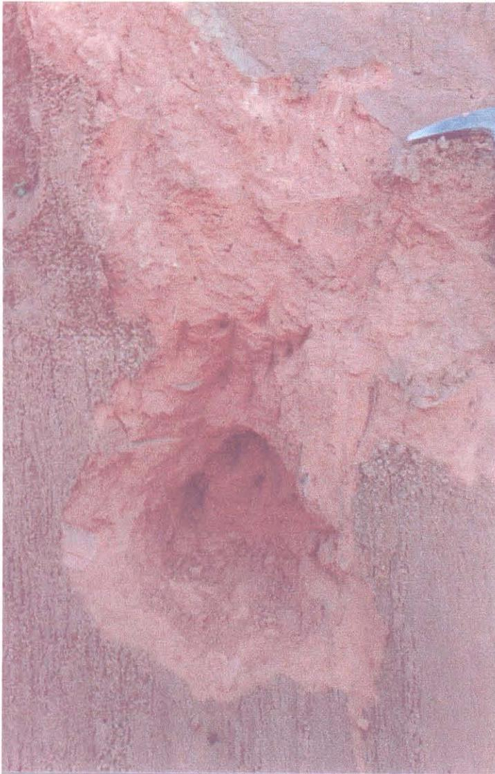
Figura 5.16 - Detalhe do Horizonte Ferruginoso ( fácies Concrecionário), sendo preparado para amostragem com anel de parede fina, jazida de barro e piçarra da empresa Terraplena, ilha do Outeiro Ponto O5.
