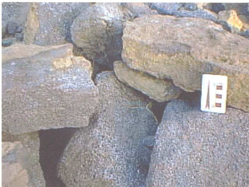
Figura 5.46 – Detalhe do material a ser utilizado na fundação de casa Horizonte Ferruginoso
