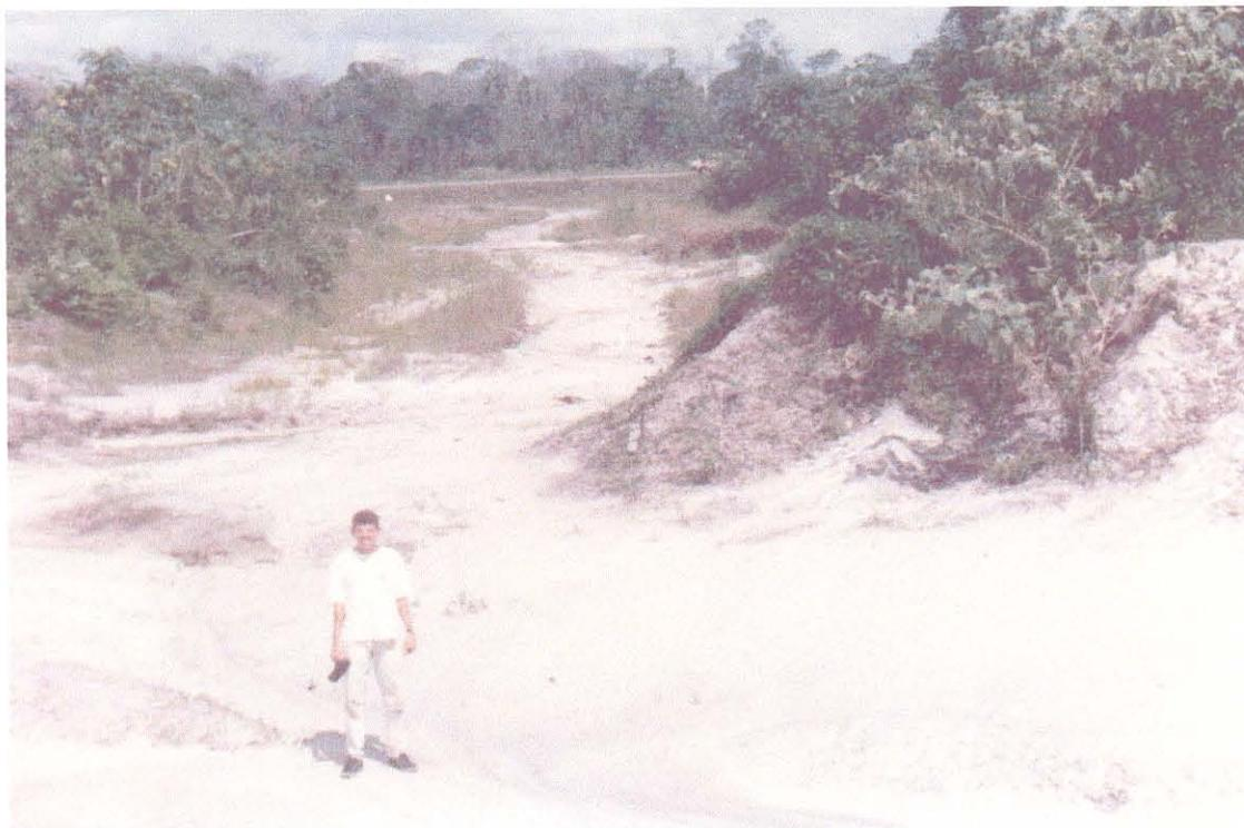
Figura 5.11 - Horizonte de Solo, fácies Arenosa, em jazida de extração de areia desativada, o que ocorre quando o nível d'água é exposto, devido às dificuldades de trafegabilidade, Ponto M21.
