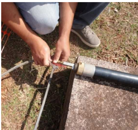
Figura 3.12: Posição das mangueiras sendo acopladas à sonda (autor).
