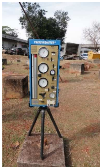
Figura 3.6: Unidade de controle do ensaio com unidade automatizada de aquisição de dados (autor).
