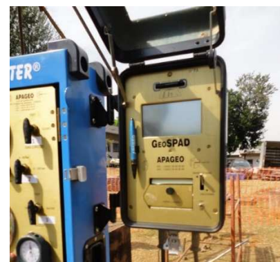
Figura 3.9: Unidade automatizada de aquisição de dados (autor).
