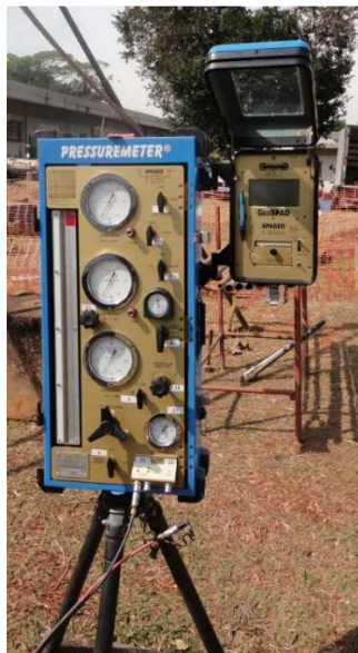
Figura 3.8: Unidade de controle com sistema de aquisição automática de dados (autor).
