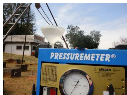
Figura 3.7: Funil de preenchimento do reservatório de água ou volumímetro (autor).
