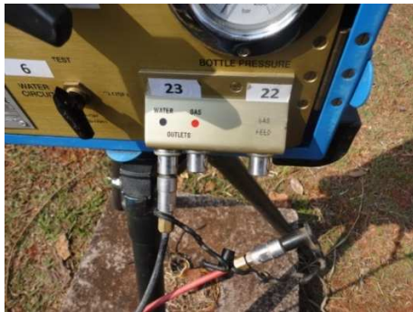
Figura 3.10: Posição de entrada das mangueiras no sistema da unidade de controle (autor).
