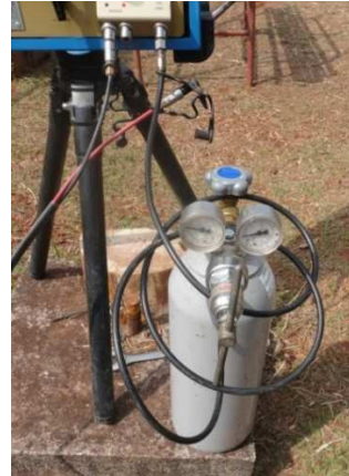
Figura 3.11: Cilindro de gás nitrogênio extra-seco utilizado para preencher as células de guarda (autor).
