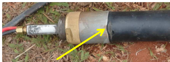
Figura 3.16: Local do rompimento da sonda durante a calibração (autor).
