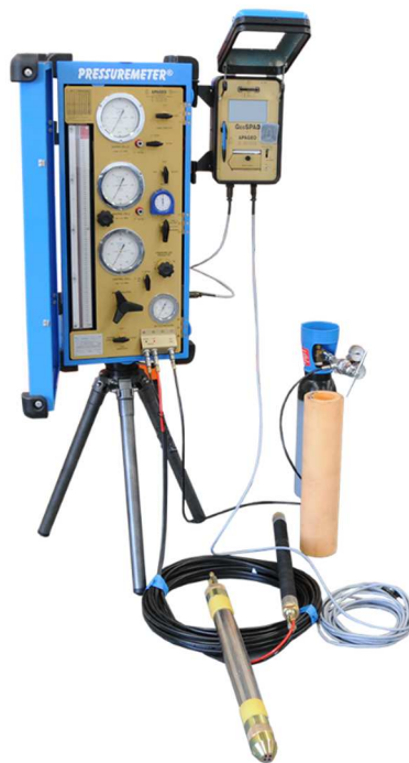
Figura 2.5: Componentes principais do equipamento pressiométrico de Ménard (Fonte: Damasco Penna. Disponível em http://www.damascopenna.com.br . Acesso em jan. 2017.)
