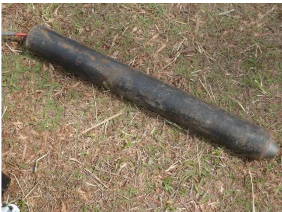
Figura 3.15: Sonda dentro do tubo rígido na calibração por perda de volume (autor).
