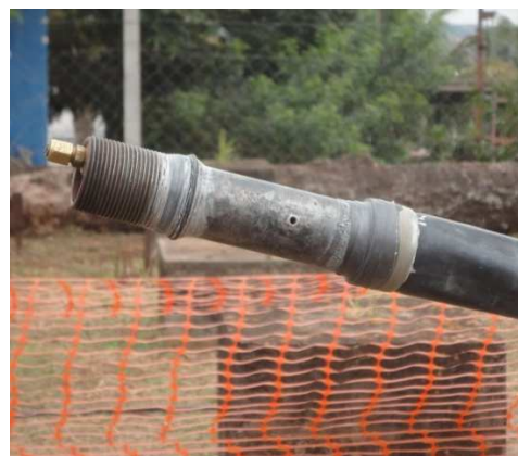
Figura 3.18: Detalhe da célula de guarda sem a cobertura de borracha (autor).
