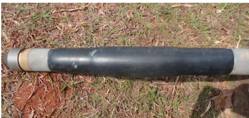
Figura 3.14: Sonda na calibração ao ar livre, por perda de pressão (autor).
