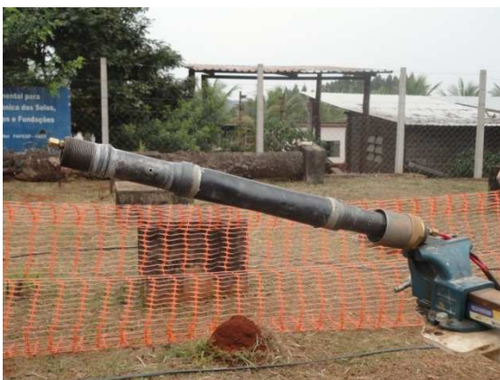
Figura 3.17: Detalhe da sonda sem sua membrana de borracha (autor).
