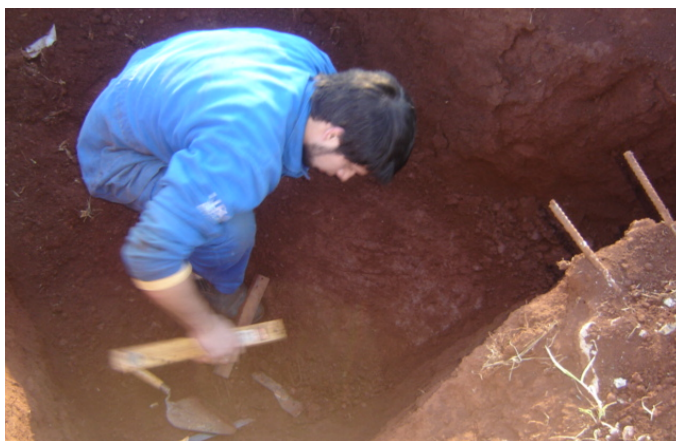
Figura 3.19 - A preparação do solo compactado para ensaio de placa
