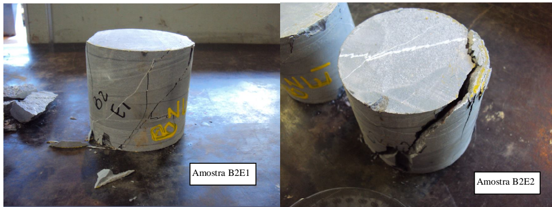
FIGURA 19 – DETALHE DAS AMOSTRAS B2E1 E B2E2 DOS PLANOS DE RUPTURA CRUZANDO VEIOS PREENCHIDOS POR CALCITA
