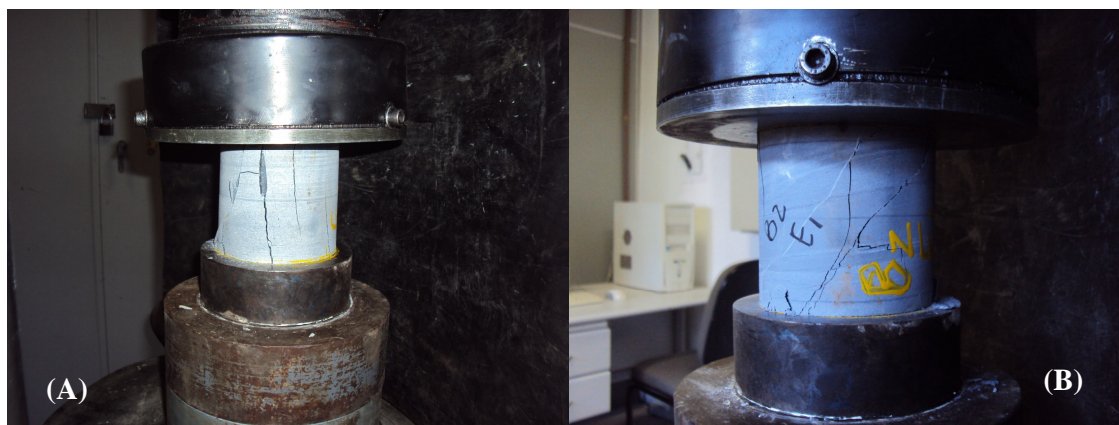
FIGURA 17 – DETALHE DOS CORPOS DE PROVA ROMPIDOS: (A) B1A1 – PLANO DE RUPTURA PARALELO AO ACAMAMENTO (B) B2E1 - PLANO DE RUPTURA PERPENDICULAR AO ACAMAMENTO
