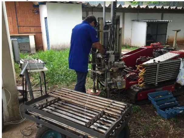
Figura 3.19 - Realização do ensaio DMT no campo experimental da Unesp de Bauru
