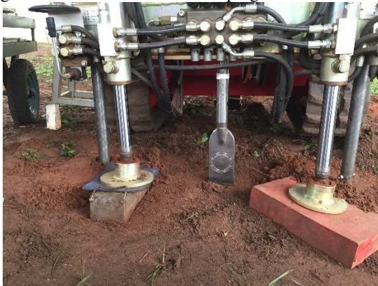
Figura 3.21 - Fontes sísmicas empregadas nos ensaios SDMT.
