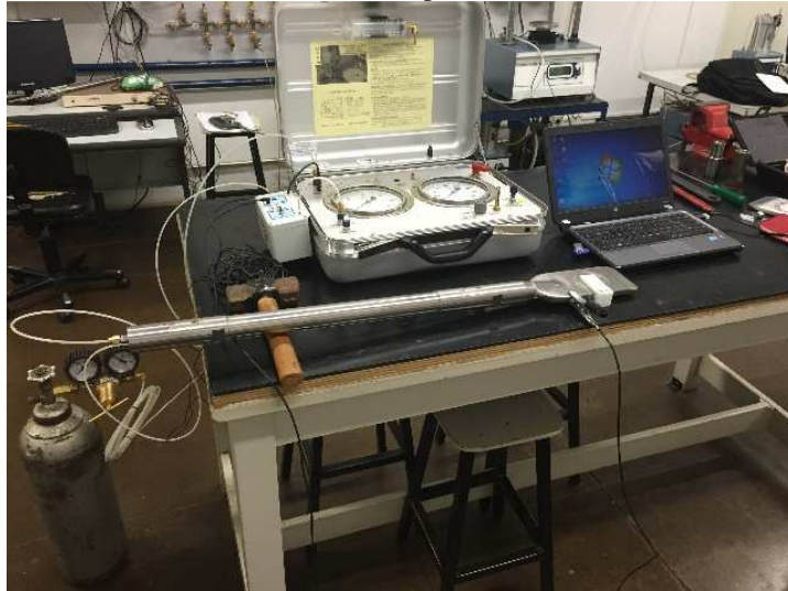
Figura 3.20 - Ponteira sísmica e calibração em laboratório para realização de ensaios SDMT.
