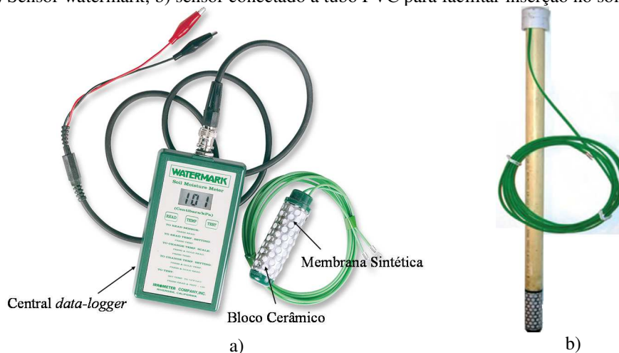
Figura 2.9 - a) Sensor watermark; b) sensor conectado a tubo PVC para facilitar inserção no solo.
