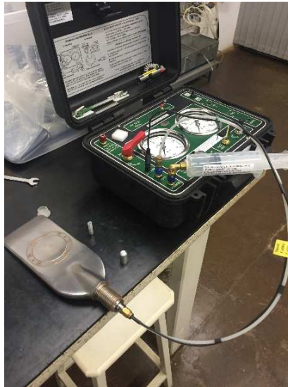
Figura 3.18 - Calibração da Lâmina do DMT em laboratório.
