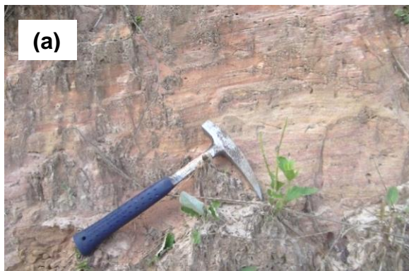
Figura 26 – Taludes na Formação Botucatu. (a) Rocha alterada mole com estratificação plano-paralela na S-2; e (b) Rupturas no solo residual na face norte do setor 1 (S-1 e S-2).
