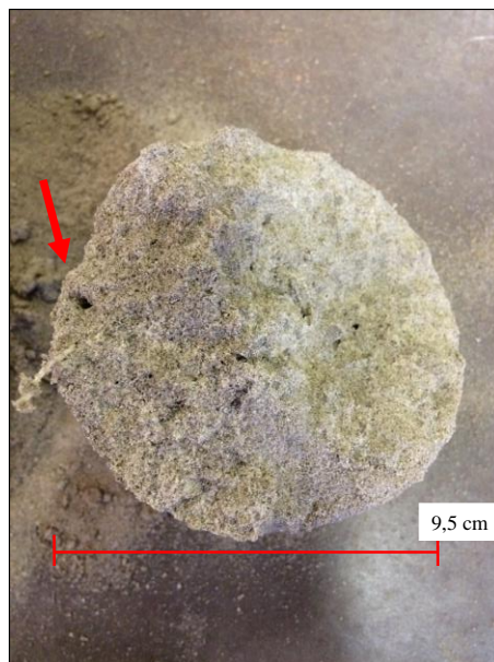
Figura 123. Presença de macroporos em uma amostra obtida em uma área com pastagem associados aos residuais da Formação Botucatu.
