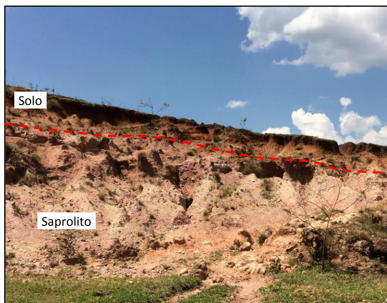
Figura 93. Exemplo de um perfil de alteração de um residual da Formação Itaqueri oriundos dos siltitos e argilitos.
