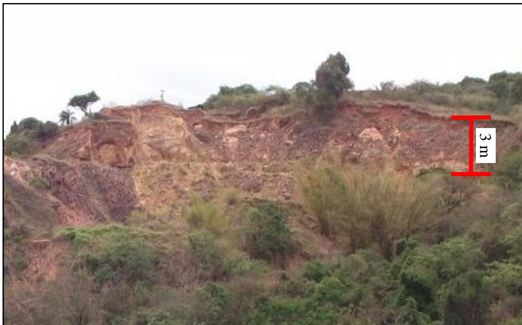
Figura 116. Perfil de um material inconsolidado residual originado dos arenitos silicificados da Formação Botucatu.
