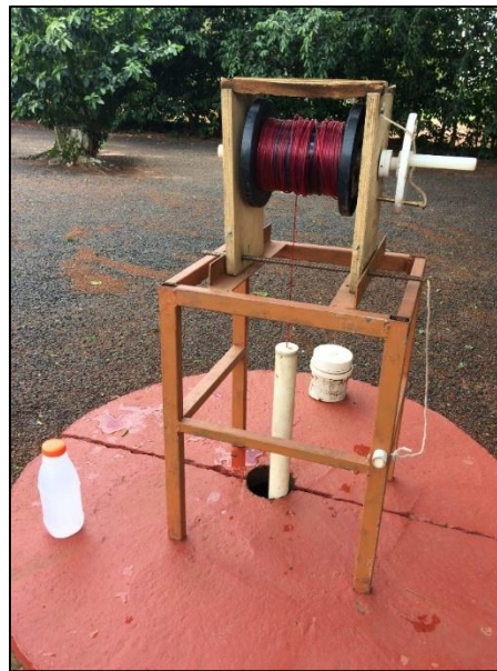
Figura 42. Amostrador utilizado para retirar amostras de água de poço.
