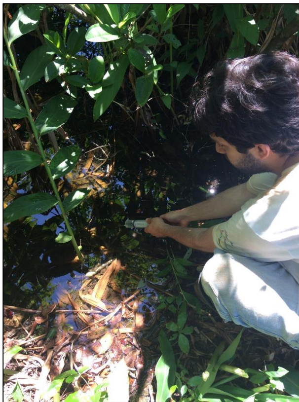
Figura 43. Coleta de água de fontes realizada a partir do uso de uma seringa de polipropileno
