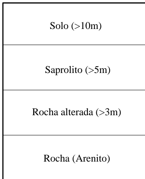
Figura 99. Perfil de alteração esquemático dos materiais inconsolidados residuais da Formação Adamantina.
