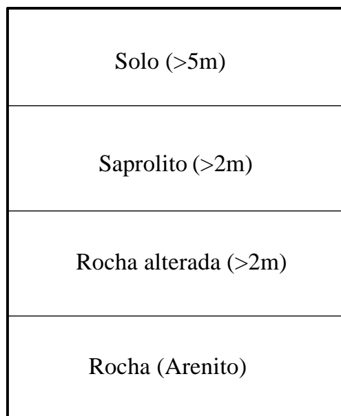
Figura 124. Perfil de alteração esquemático dos materiais inconsolidados residuais da Formação Pirambóia.
