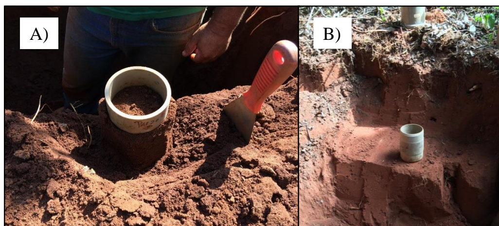
Figura 41. Colunas de PVC para amostragem: A) anel utilizado para retiradas de amostras indeformadas e obtenção dos índices físicos, B) anel utilizado para retiradas de amostras indeformadas e determinação da condutividade hidráulica saturada.
