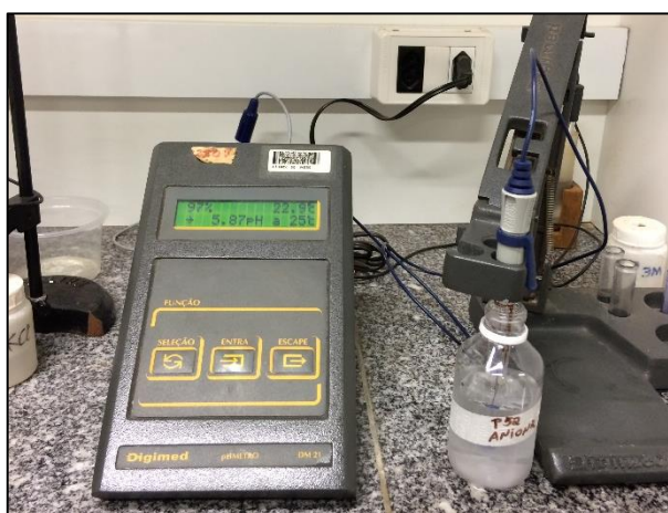
Figura 55. Foto do pHmetro da marca Digimed modelo DM21 usado para determinar a acidez das águas subsuperficiais.
