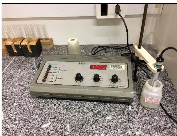
Figura 56. Foto do Condutímetro da marca Analyser modelo 650 utilizado para determinar a condutividade elétrica das amostras das águas subsuperficiais.
