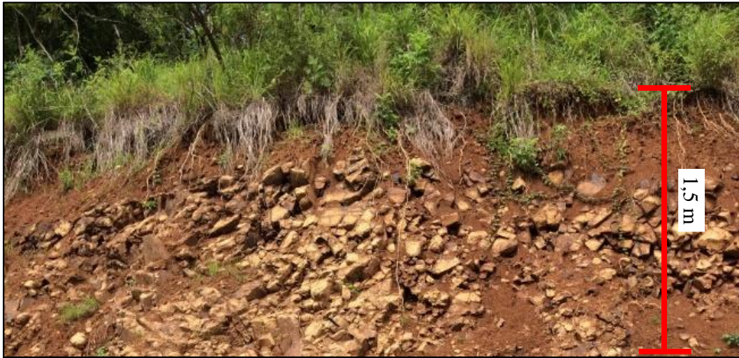
Figura 106. Exemplo de perfil de material inconsolidado residual da Formação Serra Geral pouco evoluído localizado em uma área com maior declividade.
