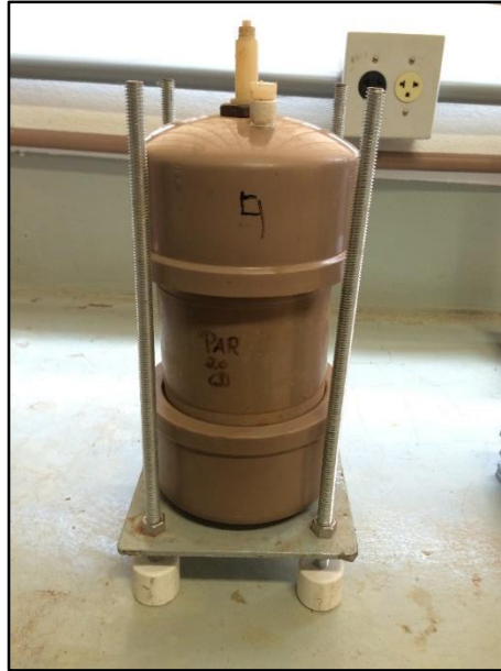
Figura 49. Tampas de PVC acopladas na base e no topo da amostra, estando apoiadas na base de metal de suporte das colunas.
