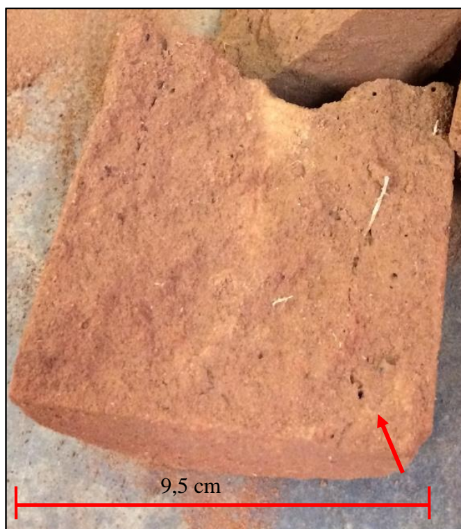
Figura 105. Presença de macroporos em um residual da Formação Adamantina em uma amostra do solo preparado para o plantio.
