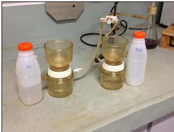
Figura 52. Conjunto de recipientes utilizados para filtração a vácuo das amostras de água subterráneas.
