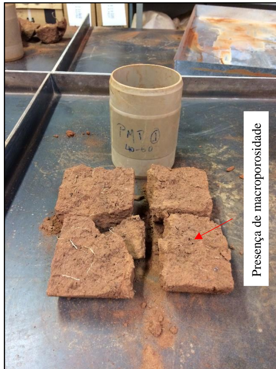
Figura 51. Procedimento de abertura da amostra após o término do ensaio de coluna, visando identificar a presença de macroporosidade.
