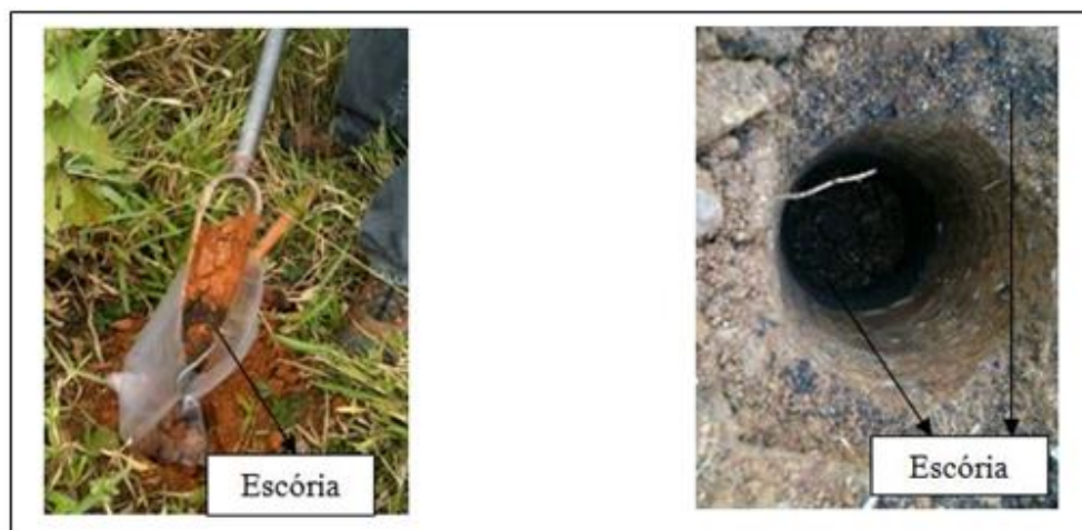
Figura 14 - Coleta do solo e do resíduo com trado manual modelo holandês. Detalhe para o furo de sondagem e presença de escória no solo (figura à direita).
