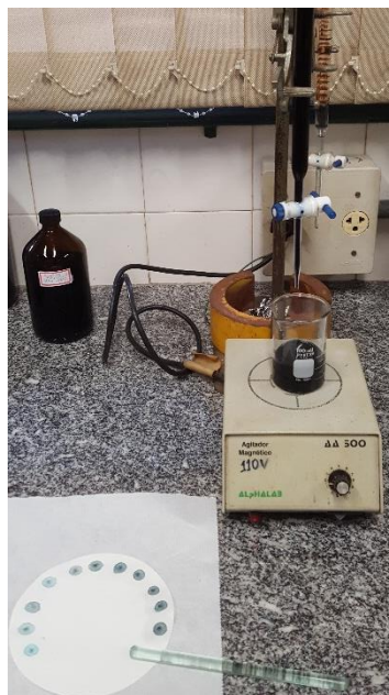
Figura 61 - Ensaio de adsorção com azul de metileno
