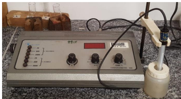
Figura 56 - Leitura da CE em condutivímetro Analyser 650
