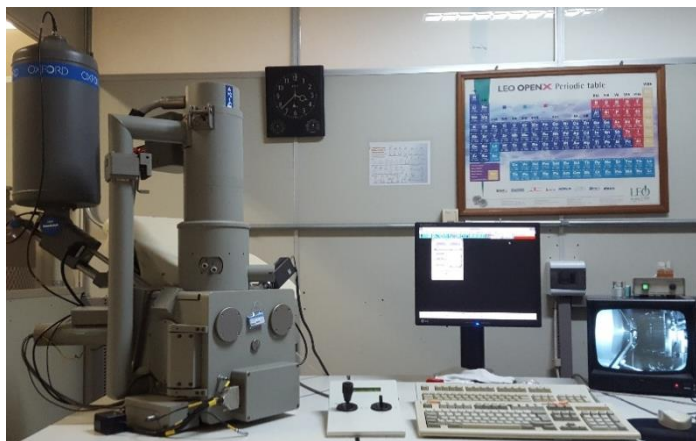
Figura 66 - Visão geral do MEV/EDS
