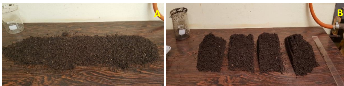
Figura 39 - Quarteamento pelo método de pilhas alongadas. A) Composto indiano; B) Composto total
