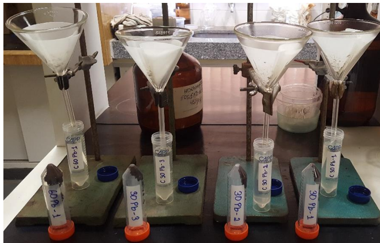
Figura 70 - Filtração de amostras de composto indiano após contato com solução contendo Pb
