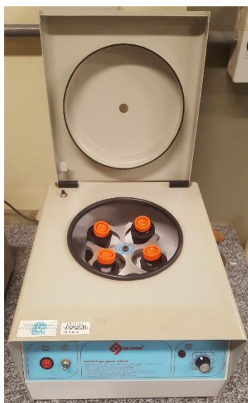
Figura 69 - Centrifugação de amostras de turfa em solução contendo Cd
