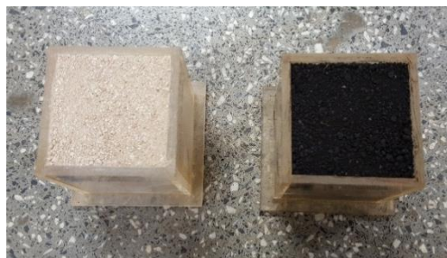
Figura 40 - Cubetas para medida do coeficiente de atenuação em massa - Ensaio granulométrico
