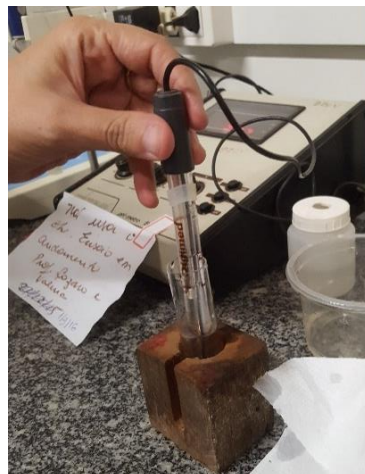
Figura 55 - PHmetro Micronal B374. Leitura do Eh
