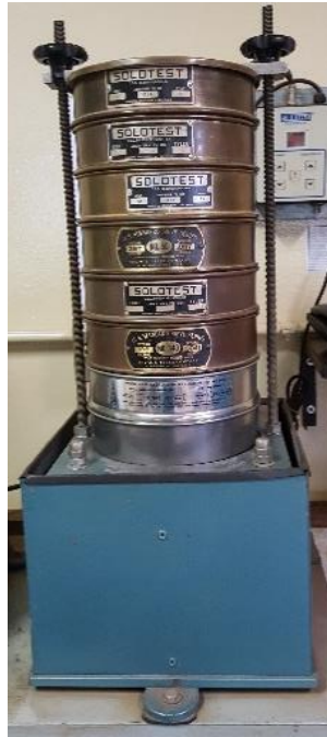
Figura 48 - Agitador mecânico com conjunto de peneiras - Ensaio granulométrico com o composto
