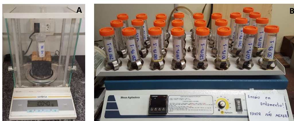
Figura 75 - Ensaio de equilíbrio em lote. A) Determinação da massa de turfa; B) Agitação do conjunto de amostras da turfa em contato com soluções contendo Pb
