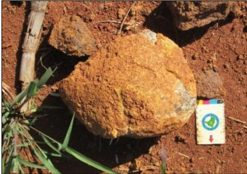
Figura 2.2: Bloco de basalto em processo de alteração no entorno da barragem de Cordeirópolis.
