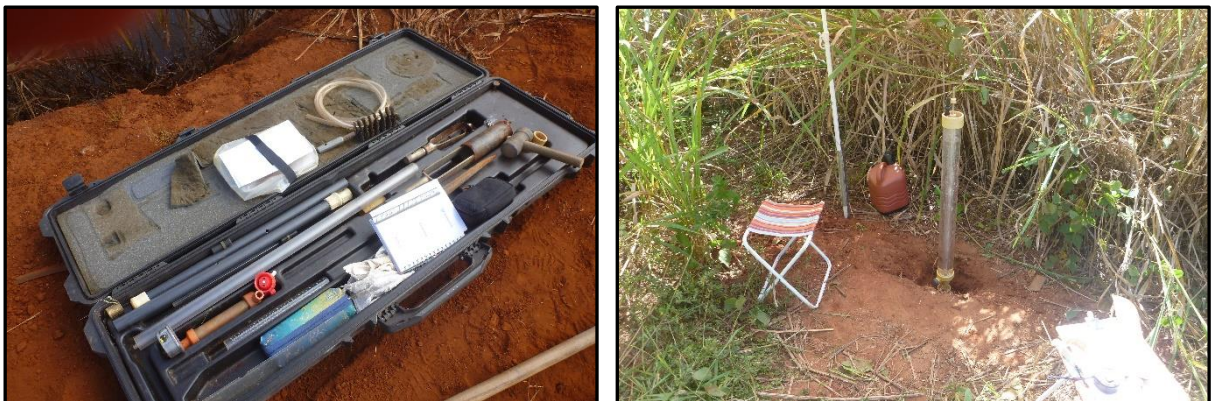
Figura 4.8: Caixa do equipamento – permeâmetro de Guelph.
