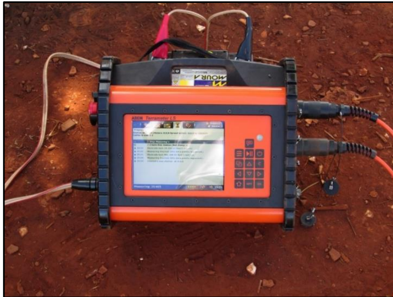
Figura 5.5: Resistivímetro ABEM Terrameter LS em operação.
