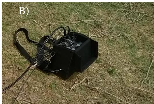
Figura 4.4: Equipamento EM-34: A) bobinas e B) processador.
