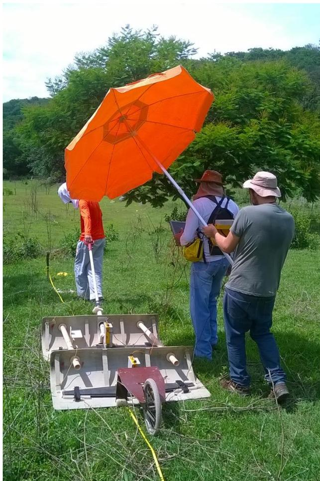
Figura 4.6: Equipamento de GPR, com antena de 100MHz.
