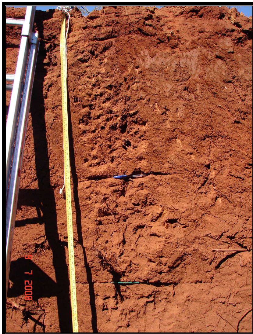
Foto 2 – Parte do perfil do solo no interior da vala com níveis marcados.
