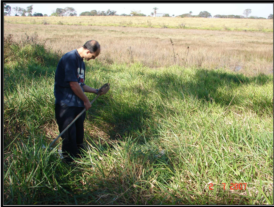
Foto 6 – Execução da sondagem a trado com a área ainda recoberta por gramíneas.
