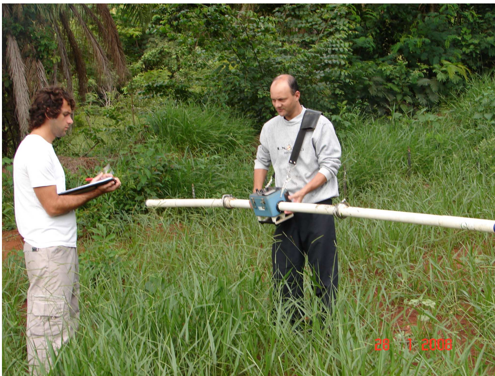
Foto 18 – Levantamento com EM-31 na área da pesquisa.
