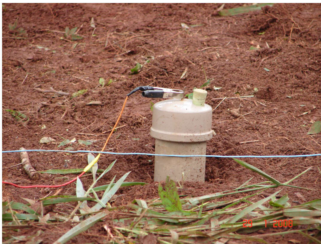
Foto 5 – Eletrodo da estação base na área da pesquisa.
