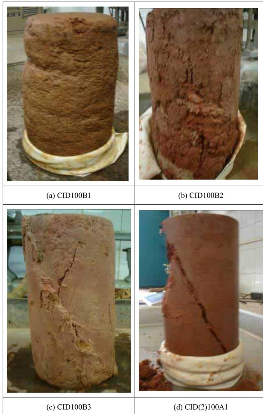
Figura 6.61. Comparação entre formas de ruptura das amostras dos blocos B1, B2, B3 e cimentada artificialmente com tensões confinantes efetivas de 100 kPa
