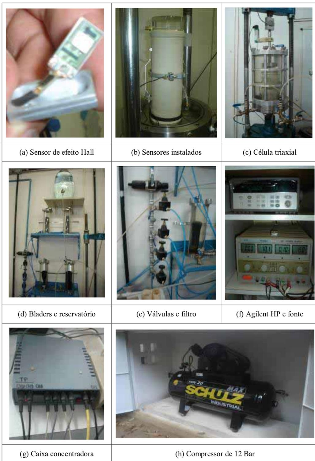
Figura 4.3. Equipamentos instalados no laboratório de Geotecnia e Instrumentação da UFPE
