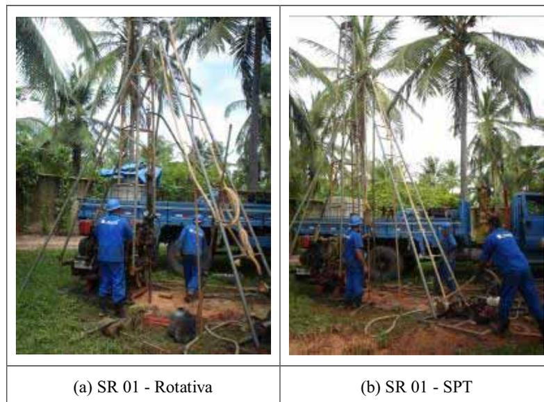
Figura 5.4. Sondagem mista (SPT + rotativa)
