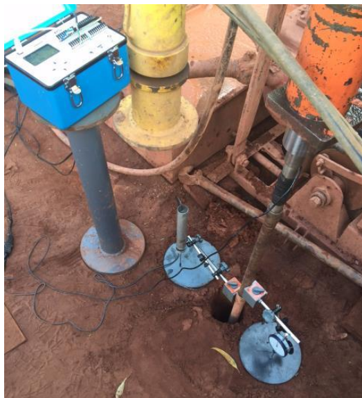
Figura 22 - Sistema de prova de carga com relógio magnético + medidor LVDT + equipamento com célula de carga + sistema de aquisição de dados.
