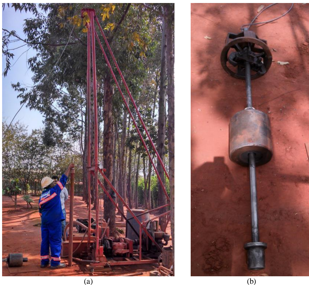
Figura 18 - Equipamento de sondagem a ser utilizado na realização dos ensaios: (a) vista geral e (b) detalhe do martelo.
