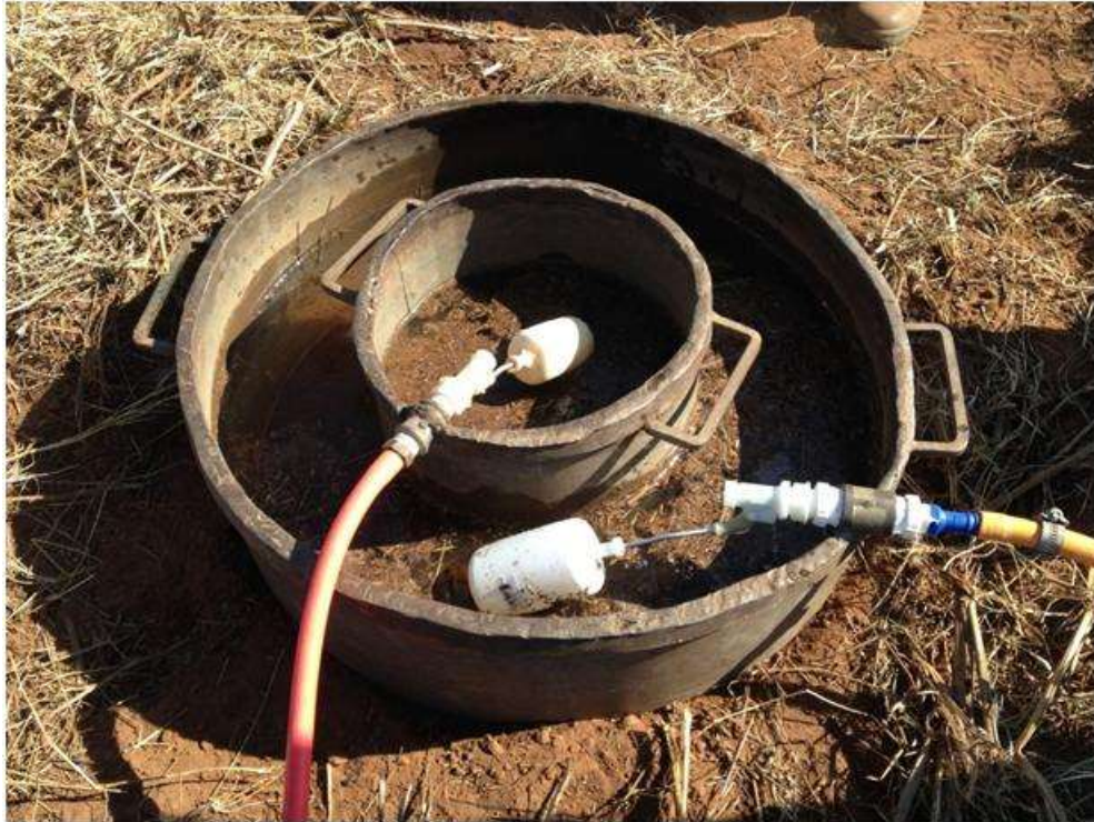
Figura 38 - Foto do Infiltrômetro Duplo Anel instalado para a realização do ensaio
