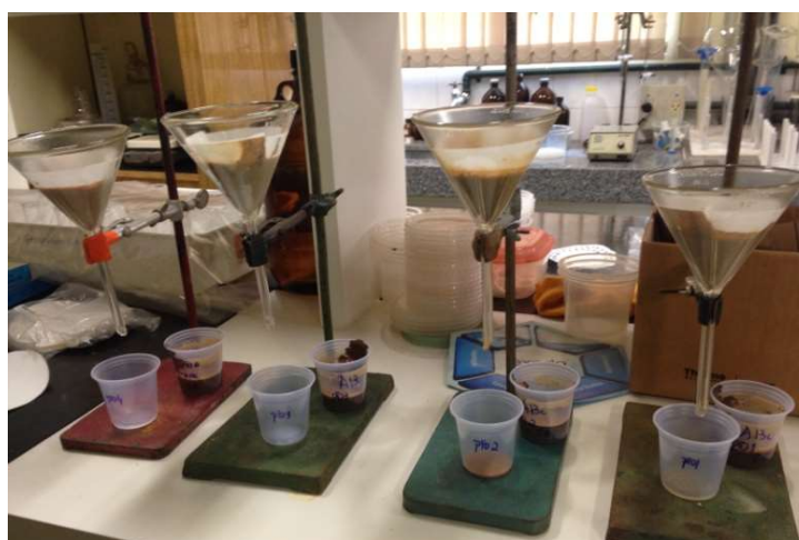
Figura 65 - Processo de filtragem da solução - Conjunto de funis com filtros.
