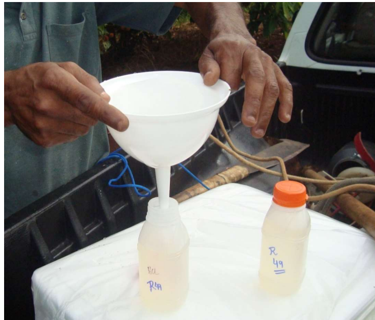
Figura 32 - Processo de filtração das amostras de água em campo.
