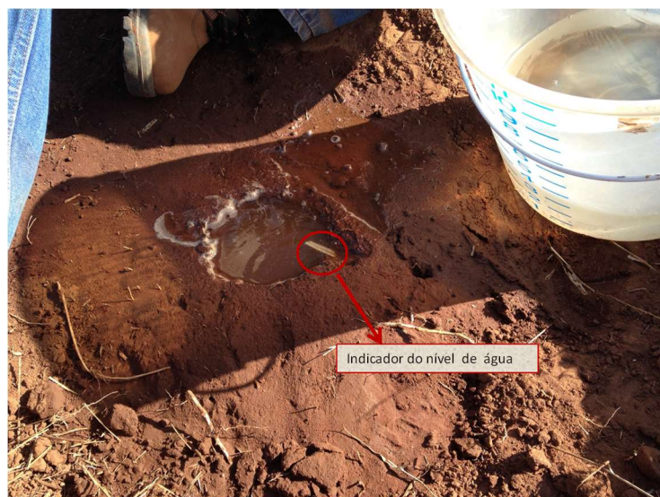
Figura 43 - Ensaio de Infiltração com carga constante.
