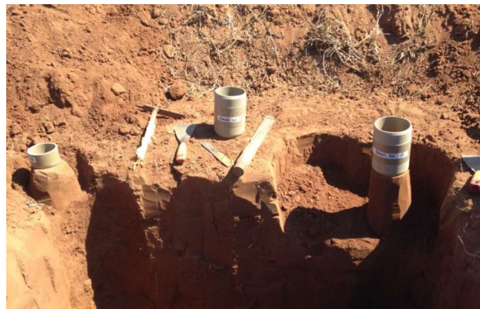
Figura 36 - Procedimento de Coleta de Amostras Indeformadas em colunas de PVC
