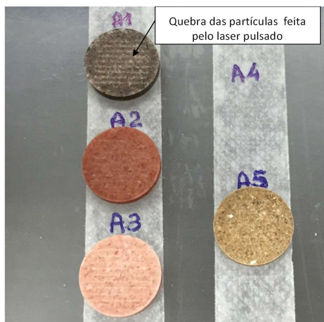
Figura 75 - Amostras com ranhuras decorrentes da vaporização pelo laser.
