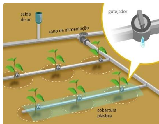
Figura 2 - Irrigação localizada por gotejamento. Fonte: http://sna.agr.br (2015).
