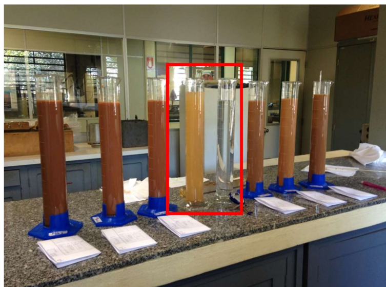
Figura 58 - Conjunto de 3 amostras separadas pelas provetas de descanso do densímetro e termômetro.
