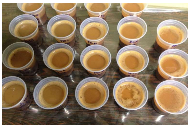
Figura 64 - Solução (solo mais água MilliQ) após agitação de 30 segundos.
