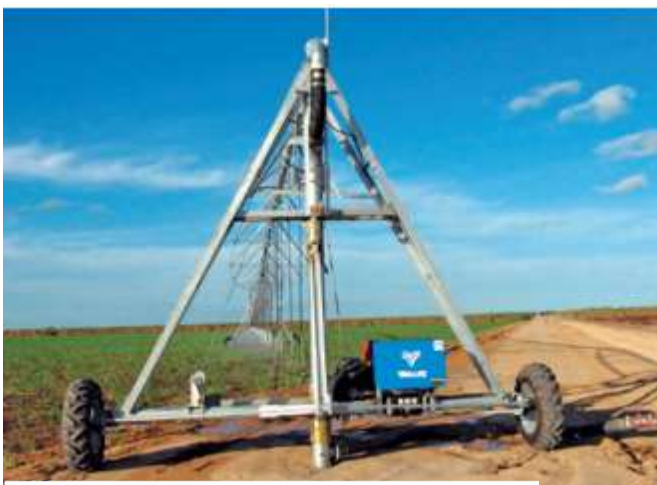
Figura 14 - Pivô central do tipo torre móvel.
