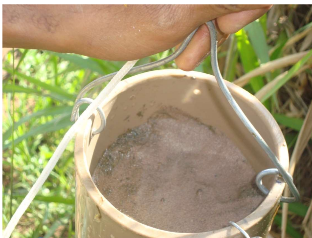
Figura 46 - Coletor de PVC utilizado para a coleta de Sedimentos
