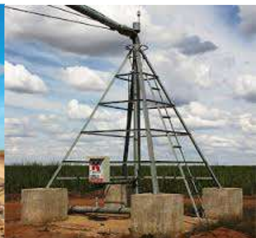
Figura 15 - Pivô central do tipo torre fixa.
