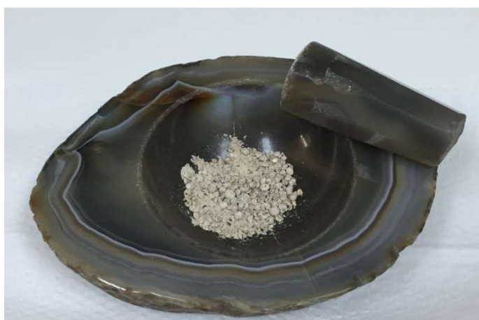
Figura 66 - Maceração da amostra de amostras de fertilizantes
