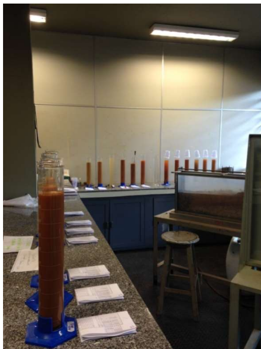
Figura 59 - Foto do Ensaio de Sedimentação em andamento.
