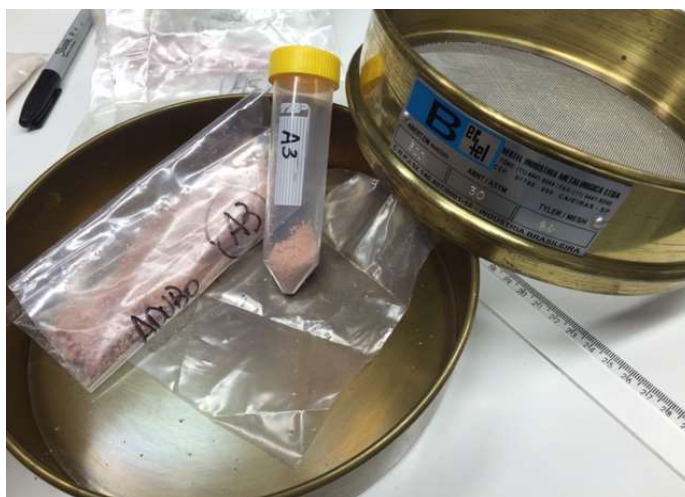
Figura 67 - Peneira utilizada para preparo da amostra de fertilizantes.
