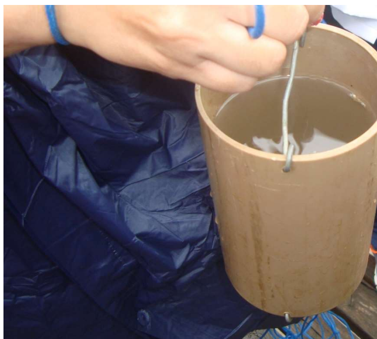
Figura 31 - Coletor em material de PVC utilizado para amostragem de água.
