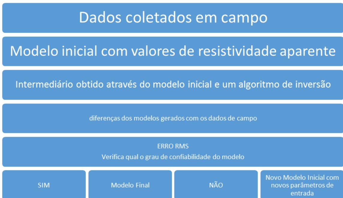
**Figura 15** - Esquema de etapas envolvendo a inversão dos dados de resistividade elétrica. Fonte: Adaptado de (Fachin, 2007).
