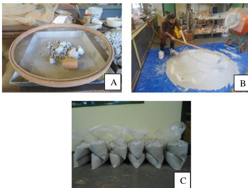
Figura 13 – Preparação da amostra de resíduo: (A) Destorroamento manual (B) Homogeneização e (C) Estocagem do material homogeneizado (Arquivo do autor).
