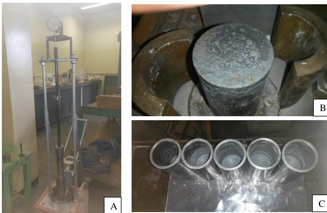
Figura 23 – Ensaio de mini-MCV: (A) Compactador mecânico com leitor de deslocamento acoplado, (B) Base de um CP em que ocorreu exsudação e (C) CPs moldados (Arquivo do autor).
