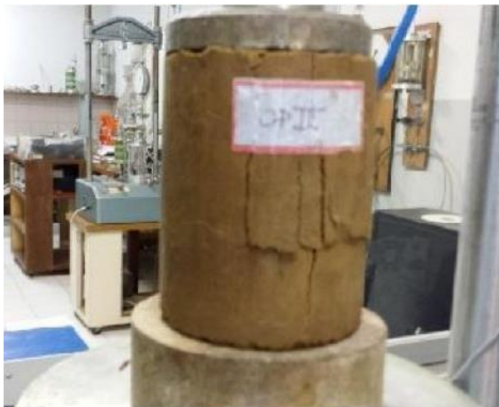
Figura 10 – Ruptura de um dos CPs submetidos à compressão simples (JOAQUIM et al., 2014).
