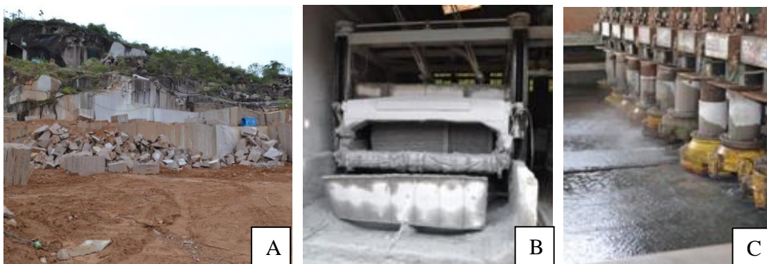
Figura 2 – Etapas da produção de placas de rochas ornamentais: (A) Extração por bancadas, (B) Desdobramento de blocos de granitos em tear multilâmina e (C) Beneficiamento (Arquivo do autor).
