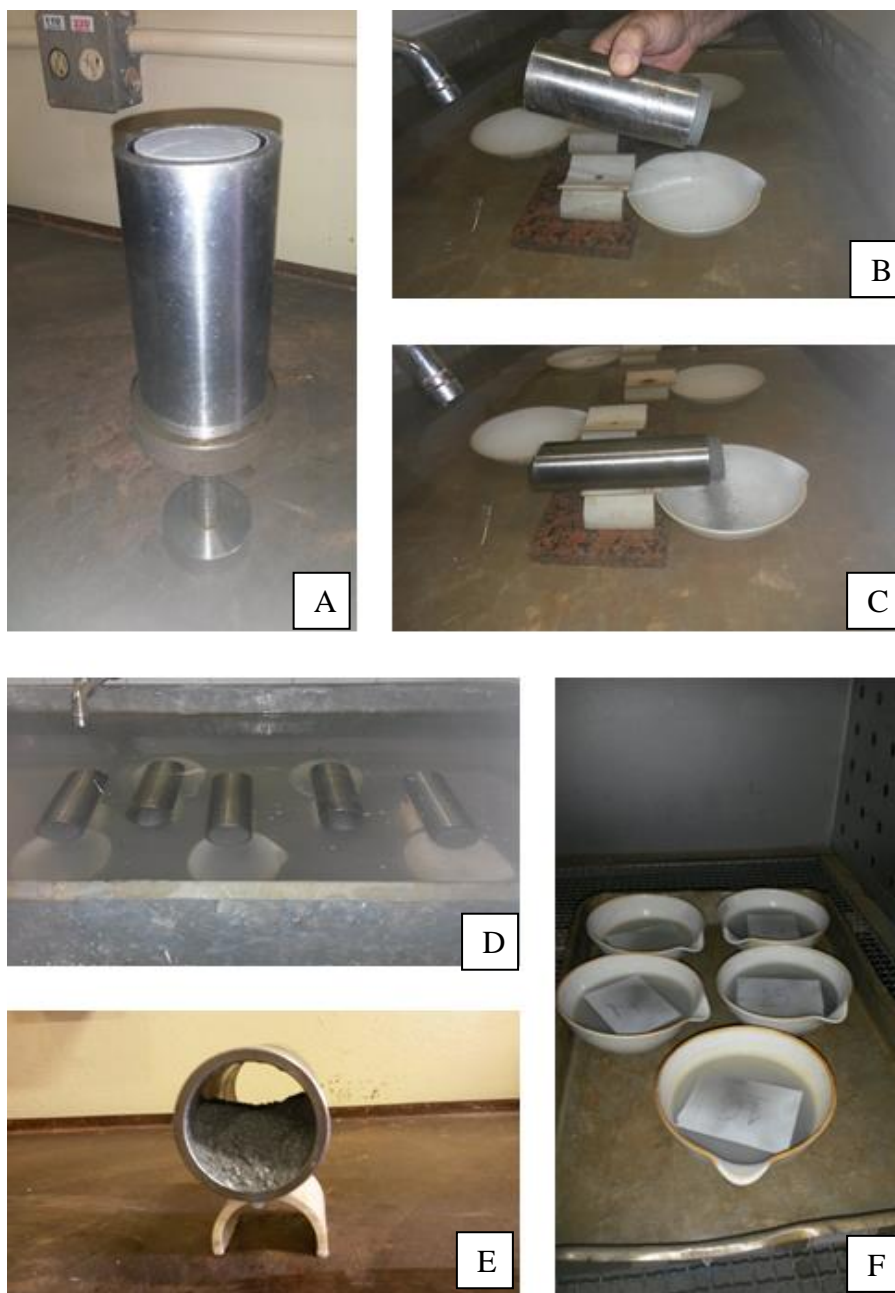
Figura 24 – Ensaio de perda de massa por imersão: (A) Com o auxílio do extrator mecânico o CP foi extraído cerca de 1 cm para fora do molde, (B) Depois foi colocado com muito cuidado sobre uma base dentro de um tanque com água, (C) O material desprendido foi coletado em uma cápsula, (D) O mesmo procedimento foi realizado com os 5 CPs produzidos no ensaio de mini MCV, (E) Após serem retirados da água os CPs estavam destruídos, (F) As cápsulas em que o material desprendido foi recolhido foram para a estufa para secagem por 24 horas e suas massas pesadas (Arquivo do autor).
