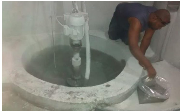
Figura 12 – Coleta manual do resíduo diretamente do poço de expurgo do tear.
