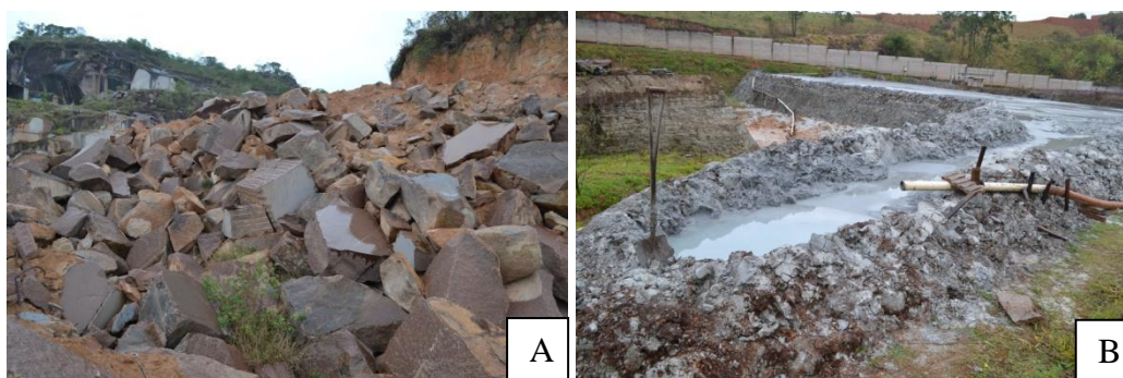
Figura 7 – Resíduos produzidos na cadeia produtiva de rochas ornamentais: (A) Extração e (B) Serragem e beneficiamento (Arquivo do autor).
