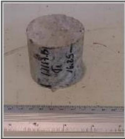
Foto 01 – Amostra 1.1117.15 (CP1), antes do ensaio de compressão.
