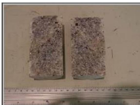
Foto 10 – Amostra 1.1117.15 (CP2), após o ensaio de tração por compressão diametral.
