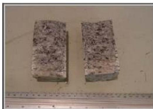
Foto 12 – Amostra 1.1117.15 (CP3), após o ensaio de tração por compressão diametral.
