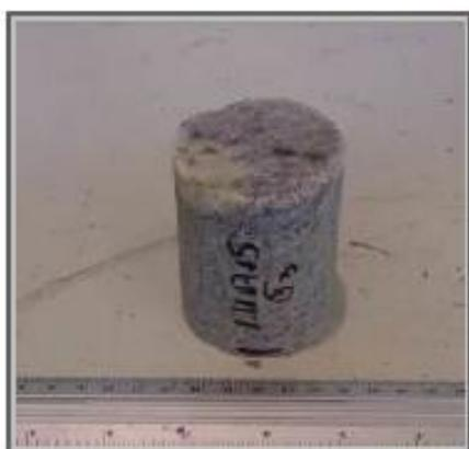
**Foto 05 – Amostra 1.1117.15 (CP3), antes do ensaio de compressão.**
