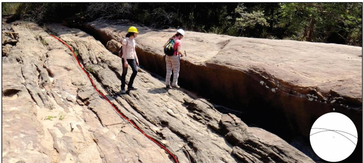
Figura 5.12 – Planos muito bem marcados, levemente ondulados, contínuos, com acentuada segregação metamórfica.
