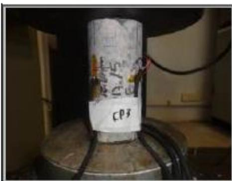
Foto 16 – Amostras 1.1117.15 (CP3), antes do ensaio de módulo de elasticidade.
