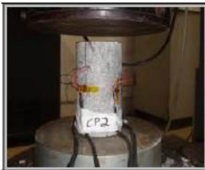
Foto 14 – Amostra 1.1117.15 (CP2), antes do ensaio de módulo de elasticidade.
