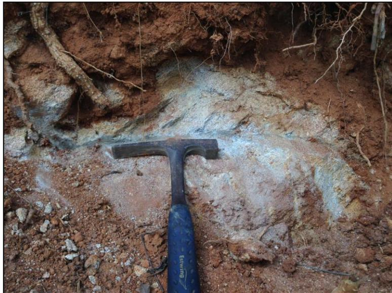
Figura 5.18 – Gnaiss bandado mapeado com direção 10/60 no P6, em talude na estrada de acesso à fazenda.
