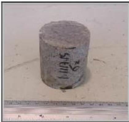
Foto 03 – Amostra 1.1117.15 (CP2), antes do ensaio de compressão.
