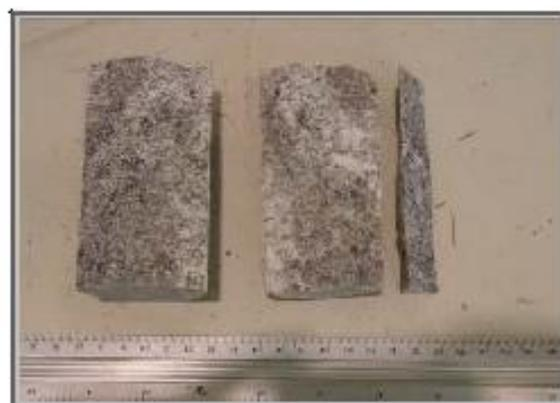
**Foto 08 – Amostra 1.1117.15 (CP1), após o ensaio de tração por compressão diametral.**
