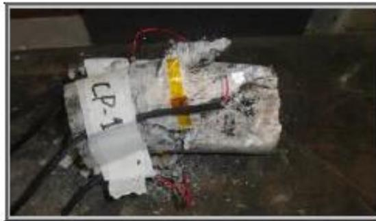
Foto 13 – Amostra 1.1117.15 (CP1), após o ensaio de módulo de elasticidade.
