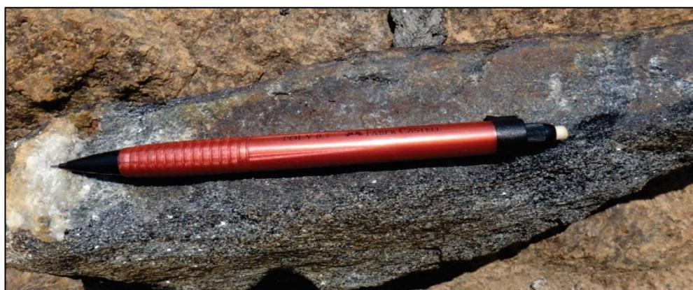
Figura 5.10 – Concentrações de biotita em amostra retirada do local.
