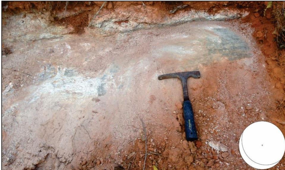
Figura 5.17 – Foliação sub-horizontal em afloramento no talude da estrada.
