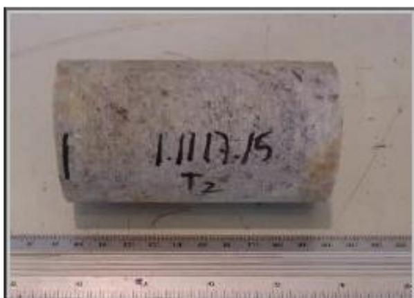
Foto 09 – Amostra 1.1117.15 (CP2), antes do ensaio de tração por compressão diametral.
