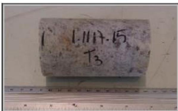
Foto 11 – Amostra 1.1117.15 (CP3), antes do ensaio de tração por compressão diametral.
