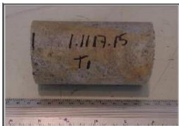
**Foto 07 – Amostra 1.1117.15 (CP1), antes do ensaio de tração por compressão diametral.**
