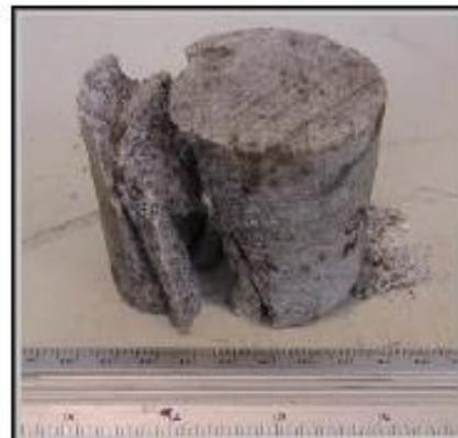
Foto 04 – Amostra 1.1117.15 (CP2), após o ensaio de compressão.
