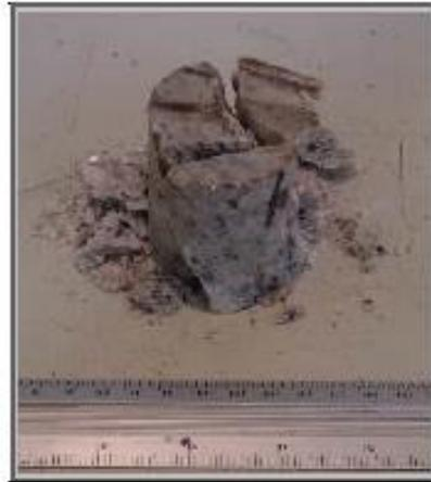
Foto 02 – Amostra 1.1117.15 (CP1), após o ensaio de compressão.
