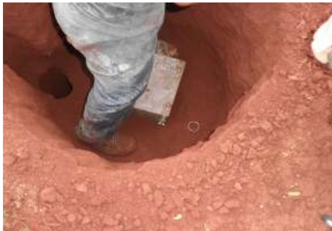
Figura 4.1. Coleta de amostra indeformada com auxílio do “gabarito”
