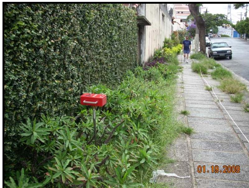
**Figura 25:** aquisição de dados de emissão de Rn com equipamento Markus 10
