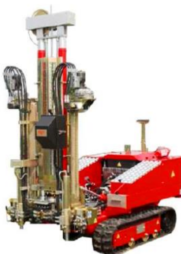
Figura 23. Sistema multifunção para ensaios de campo, modelo Pagani TG 63-150 DP-CPT
