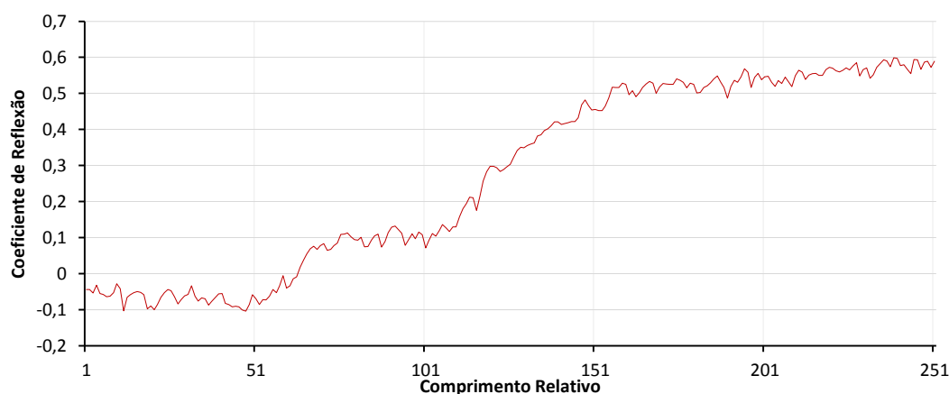
a.) Registro de onda a 1.12 m de profundidade.
