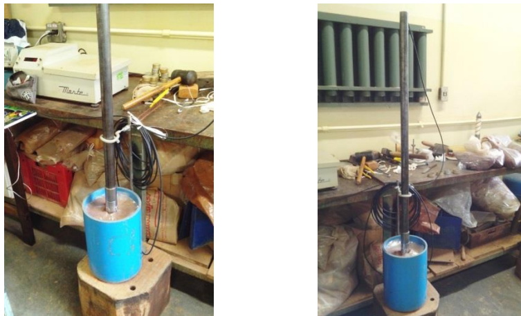
Figura 68. Haste do ensaio CPT utilizada na calibração.
