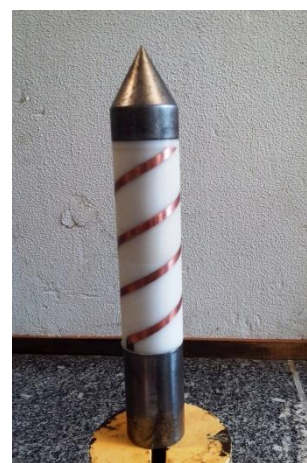
c.) Poliacetal + núcleo interno de aço + ponta
