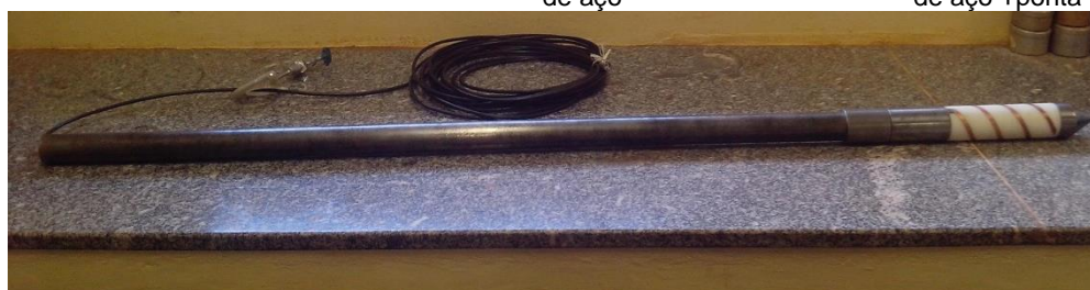
d.) Poliacetal + núcleo interno de aço + ponta + haste
