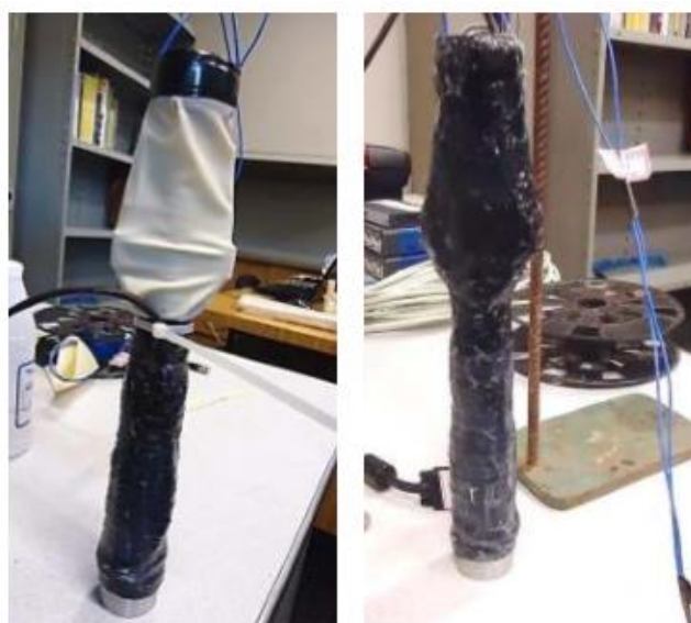
Figura 3.9 Proteção mecânica dos sensores instalados nas hastes instrumentadas (Morais, 2014).
